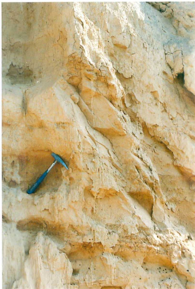
Figura 6. Fracturas de buzamientos medios en depósitos cuaternarios de limos y arenas del río Matarraña. Estación 3. (Coordenadas U.T.M.: 31TBF761685).
