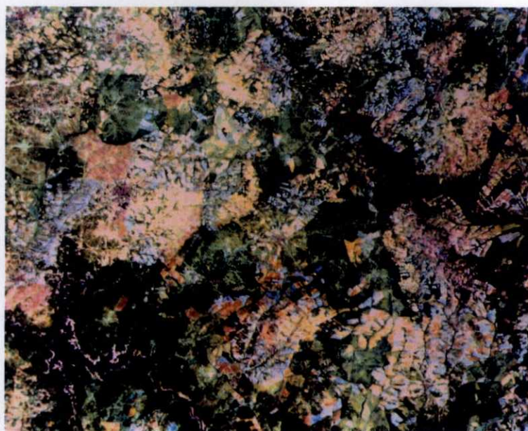
fig.6. Composición en falso color con las bandas 2 (azul), 7 (rojo) y 5 (verde) del sensor thematic mapper corregidas atmosféricamente. Hoja de Almeida de Sayago.
