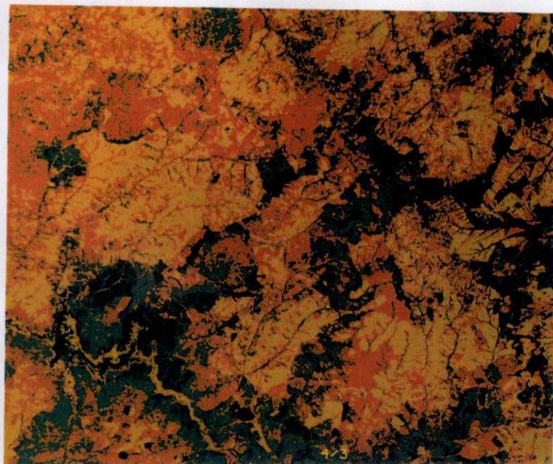
fig.5. Segmentación de números digitales en el cociente entre las bandas thematic mapper 4 y 3. Colores asignados a valores de bajos a altos, que corresponden a zonas con densidad de recubrimiento vegetal proporcional: amarillo, naranja, verde claro, verde oscuro. Hoja de Almeida de Sayago.
