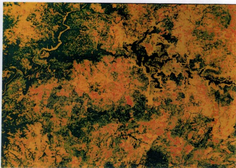
fig.1. Segmentación de números digitales en el cociente entre las bandas thematic mapper 4 y 3. Colores asignados a valores de bajos a altos, que corresponden a zonas con densidad de recubrimiento vegetal proporcional: amarillo, naranja, verde claro, verde oscuro. Hoja de Fermoselle.
