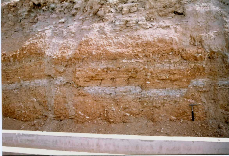
Foto 7.- Pequeñas fallas normales afectando a un tramo arcilloso rojo (unidad 12) con elevado contenido en yeso, manifestado como yeso nodular. Inmediaciones de Mediana (punto de observacion n° 15).
