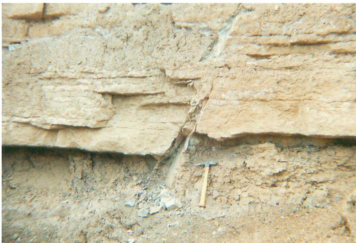
FOTO 7. Falla normal con un salto aproximado de 20 cm. en donde el plano aparece relleno por yeso fibroso en donde quedan marcada las estrías. Se localiza en la misma estación que la foto anterior.
