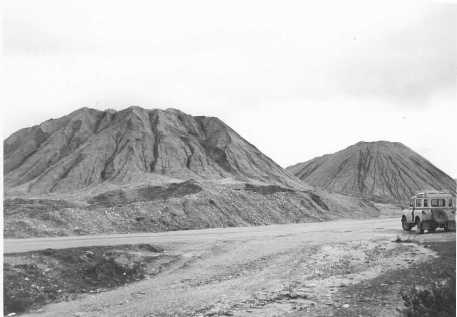
RN 204.— Depósitos artificiales de áridos con destino al sector de la construcción, procedentes de las explotaciones de gravas y arenas de las terrazas antiguas del río Miño. Cra de Salvatierra de Miño a Las Nieves, Tno. Municipal de Sta. M a de Oleiros.
