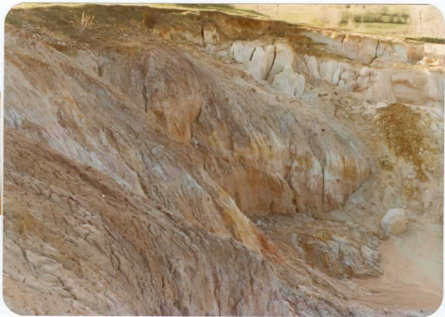
14-08-AD-JM-2009. - Aspecto típico del Utrillas ( C_{16-22} ). Arcillas de tonos abigarrados y arenas.
