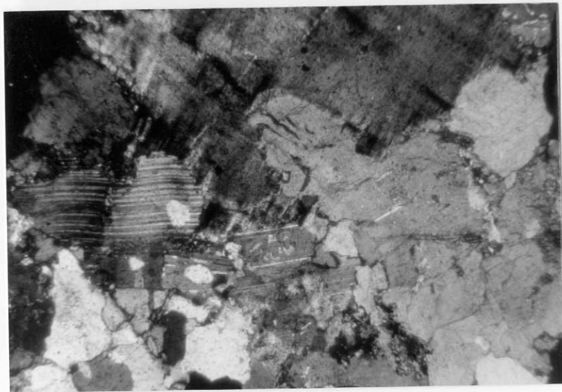
0708-IM-FR-0090.-Aspecto general del granito de dos micas deformado .LPx1,D32 .
