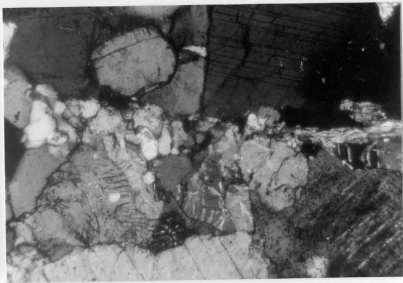
0708-IM-NB-654.-Mirmequitas asociadas a zonas de microcrenulación y cataclasis en granito de dos micas.
