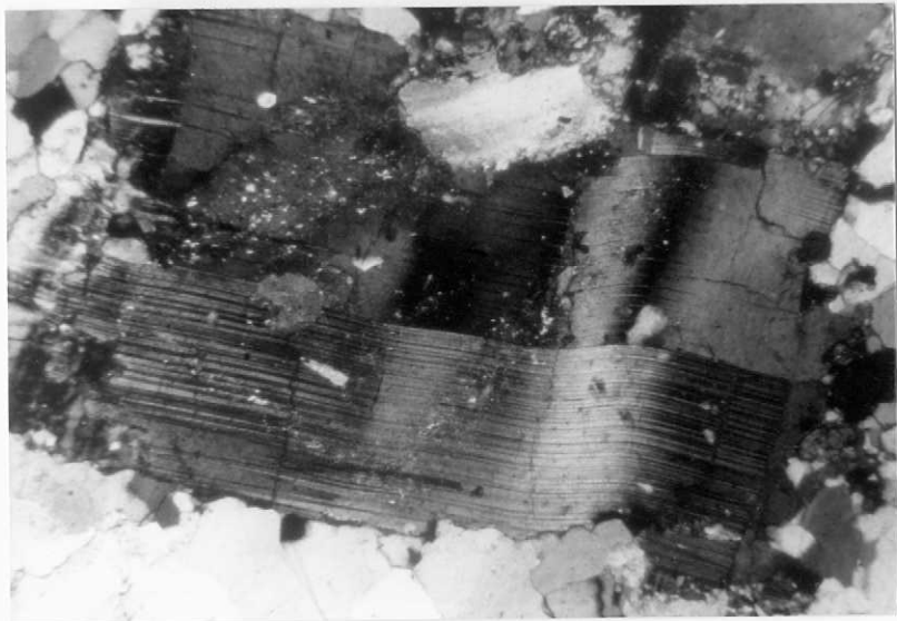
0708-IM-FR-0090.-Plagioclasa deformada . LPx2,D 78 .
