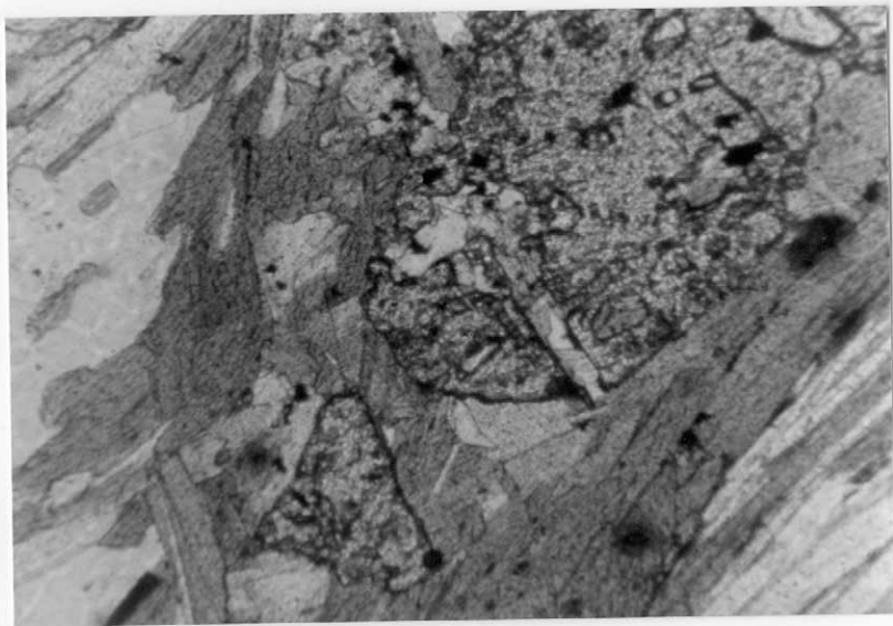
0708-IM-NB-0639.-Aspecto de texturas en paraneises de la Serie de Villalba . LPx2, D 78 .
