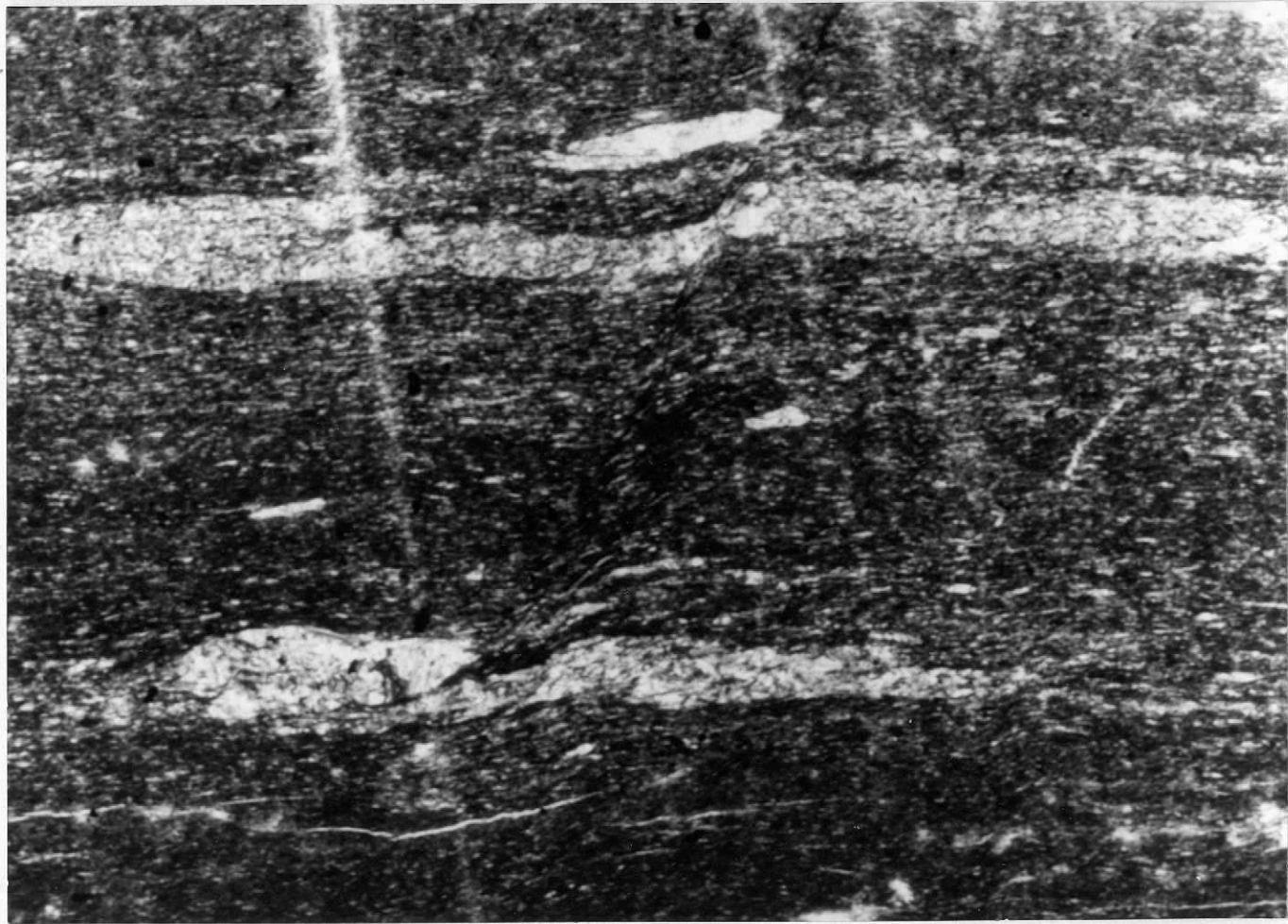
VA 5058. - Esquistosidad de flujo intersectada oblicuamente por una incipiente crenulación manifestada como kinks normales. 570X
