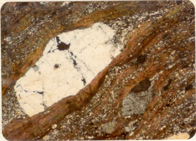
PM-207.) Esquisto micáceo con clas- tos de cuarzo y feldespato ("Ojo de Sapo" de grano grueso (PCζ)). Clas- tos de cuarzo y plagioclasa con som- bras de presión. N//, X18.
