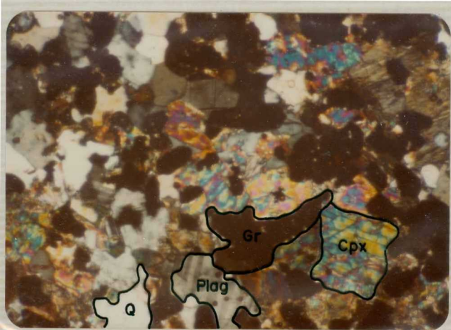
PM-40.) Granofels (G). Minerales sin retromorfizar ( M_1 ). NX, X36. Cpx:clinopiroxeno, Plag:plagioclasa Gr:granate, Q:cuarzo.
