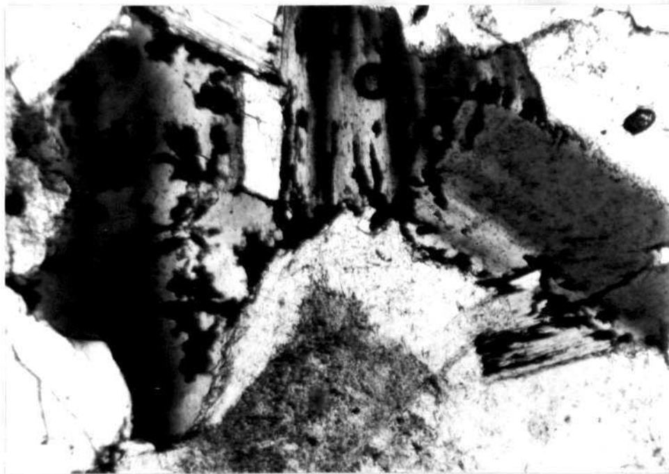
0206-IM-NB-0051.-Biotitas cloritizadas . LNx2 .D 80.
