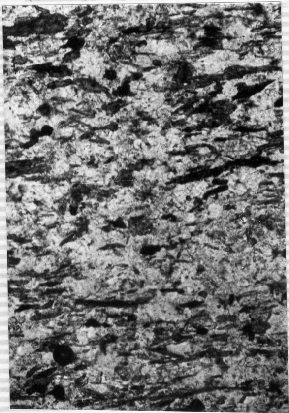
514.- Aspecto de la esquistosidad principal S_1 en una arenisca de la Serie de Villalba. Cuarzo alargado biotita paralela, GL-514. N // 140 (PC \xi + \xi A).
