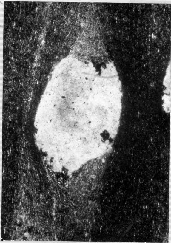
9.- Pizarra carbonosa, con clastos de cuarzo que dan sombras de presión Capas de tránsito PM-9 N // 90 ( CA_1P_2 ).
