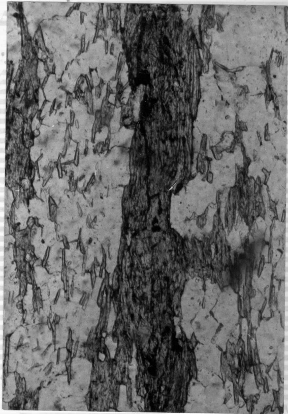
1.012.- Cuarcita con textura grano blástica orientada. Cuarcita de -- Candana inferior. MC. 1.012. N // (140 (CA 1 )).
