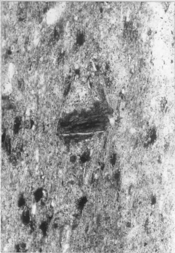
547.- Pizarra sericítica con porfiroblastos de biotita post. S_1 . que ha sufrido un aplastamiento posterior - dando sombras de presión. Intercalaciones pizarrosas en la Cuarcita de Candana Superior. N// 140. (CA 1 q).
