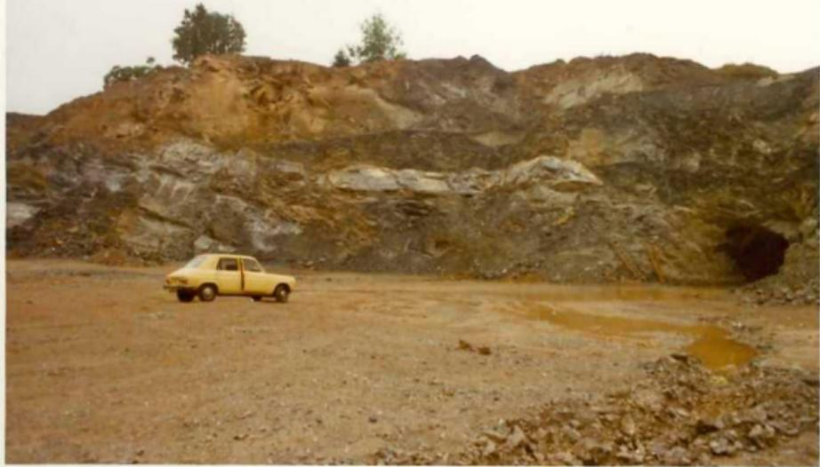
818.- Canteras en las calizas de Moeche. Al fondo y sobre túnel de entrada serpentinitas en contacto directo.
