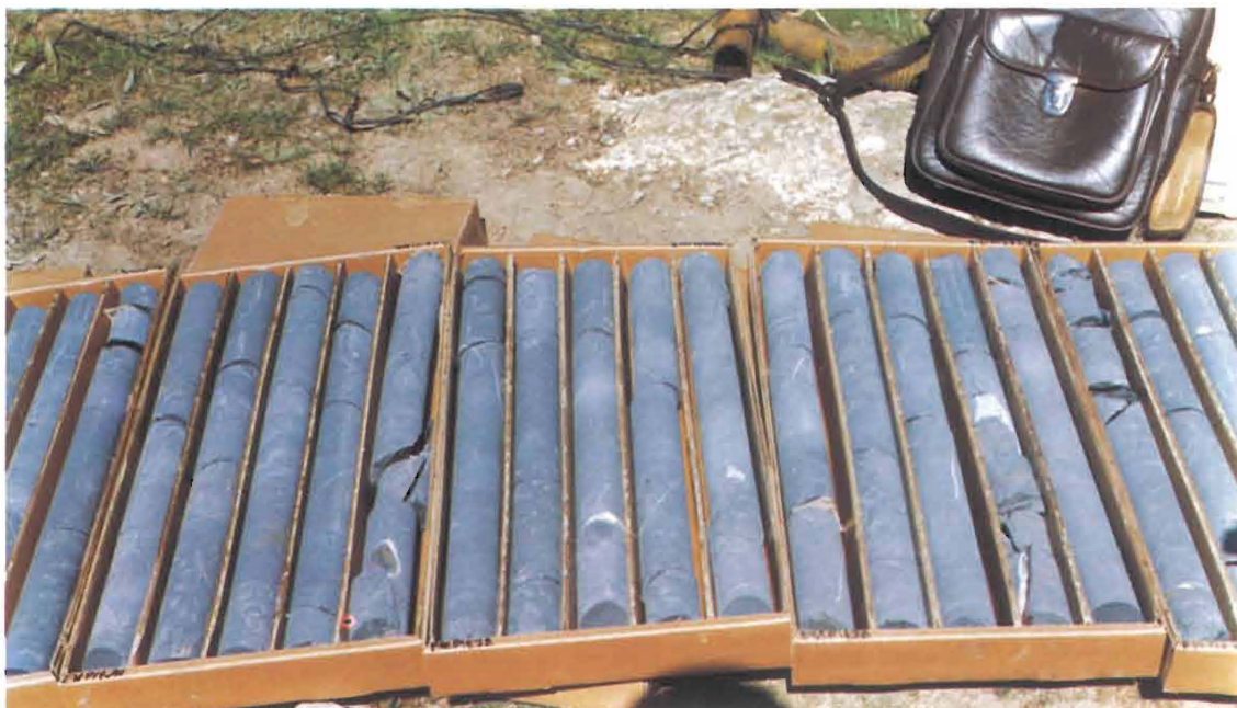
Figura 21. Testigos de un sondeo de reconocimiento para aguas subterráneas (Proyecto Hidrogeológico de Soria) (Foto E.S.)
