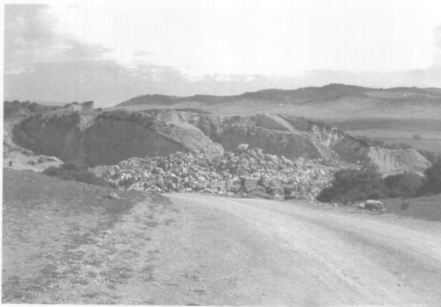
Foto 5.— Explotación de calizas triásicas para áridos en el Parralejo
