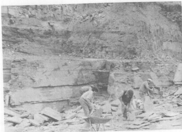
Foto 4.— Explotación mármol de areniscas rojas del Buntsanstein para la obtención de losas utilizables en construcción (revestimiento de zócalos) cubiertas y jardinería
