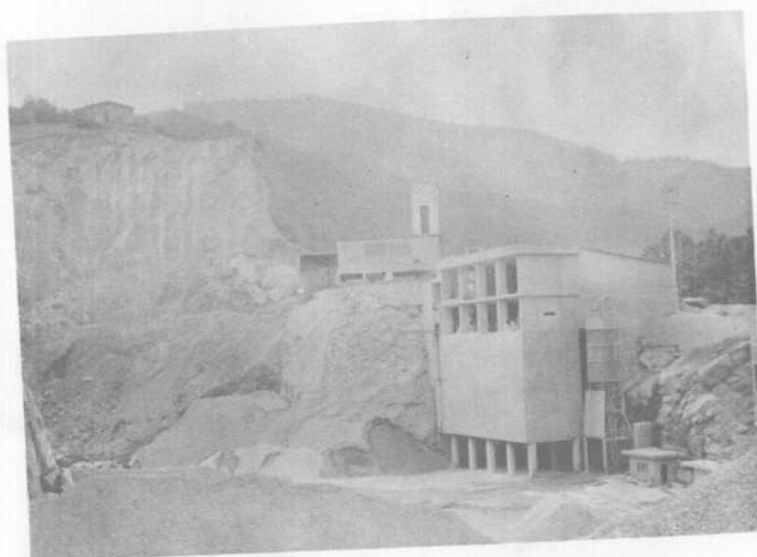
Foto 8.- Explotación de caliza eocena, en la Sierra de Alaiz, para áridos de trituración.
