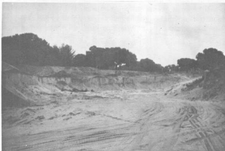
Foto 3.— Frente de explotación en arenas eólicas de la faja costera en la Bahía de Alcutia
