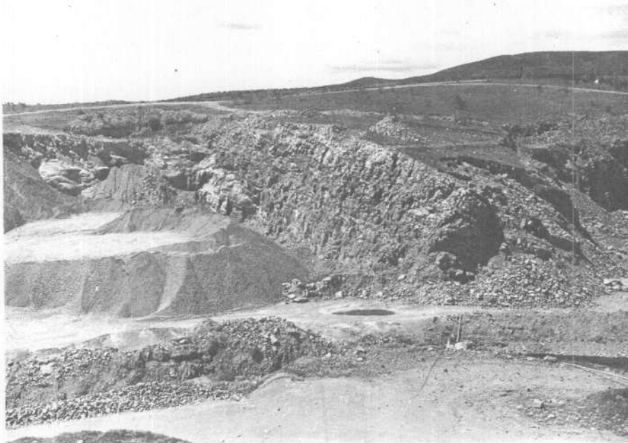
Foto 3.— Importante cantera de roca pizarrosa cámbrica para obtención de áridos de trituración, cerca de Plasencia. Cantera de Gilmorquilla (E-56)
