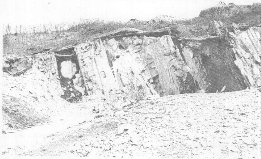
Foto 8.— Cantera de caliza en Navarredonda (E—147) para obtención de áridos de trituración.
