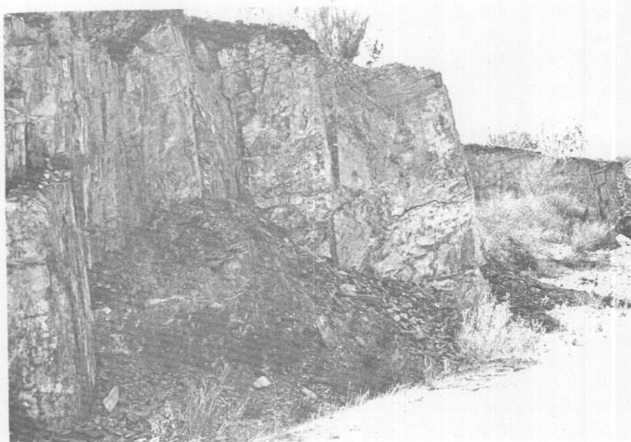
Foto 12.— Cantera de pizarras cámbricas para áridos, en Valverde del Fresno (E-7)
