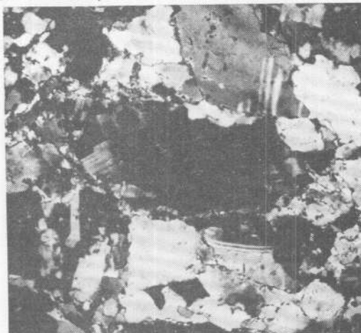
Foto 17.— Milonita cuarzo-plagioclásica. Cra. Figueras-Llansá. Nícoles cruzados. X36.
