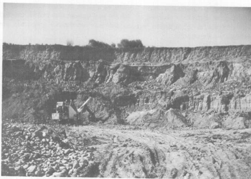
Foto 3.— Explotación por el método de bancos
