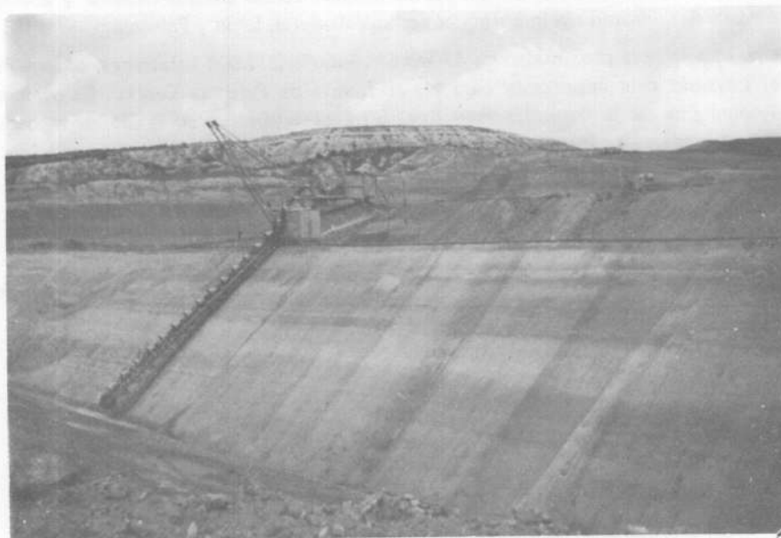
Foto 6.— Explotación por draga con cangilones
