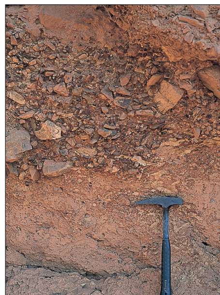
Foto 48. Mineralización aurífera en un “paleoplacer” de probable edad pliocena. Se trata de un depósito constituido por cantos de cuarcitas y pizarras en una matriz arcillosa rica en hierro. Los contenidos de oro son variables oscilando entre 0,2 y 2,1 g/t de Au. Barrancones (n° 62), distrito aurífero de La Codosera.
