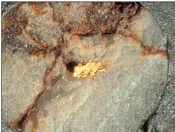
Foto 45. Oro nativo rellenando huecos y cavidades en venas de cuarzo. Sondeo Codo 27 bis a 76 metros de profundidad. Monteviejo, La Codosera. (Tamaño del grano 1 mm).
