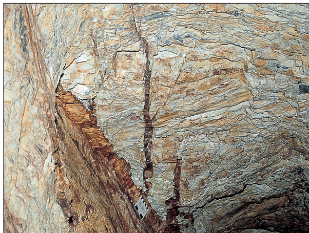
Foto 41. Ramificaciones (branching veins) de venas de orientación N20°E que conectan con venas N50°E (de mayor potencia) con mineralización de oro. La Perla de Anibal (n° 70), distrito aurífero de La Codosera.
