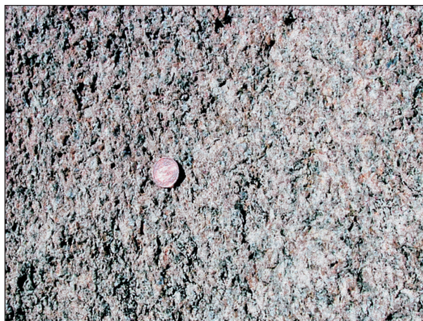
Foto 20. Leucogranito moscovítico deformado por cizallas de orientación N-S y sentido sinistorsor en el granito de Brozas.
