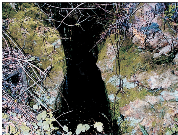
Foto 42. Galería de orientación NE-SO siguiendo la orientación de los filones de cuarzo con mineralización de oro (N30°E-N40°E). La Manzana de Oro (n° 69), distrito aurífero de La Codosera.
