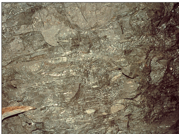
Foto 39. Disposición de la estibina (gris metálico) deformada y en “bandas” estiradas en la brecha carbonatada deformada del Devónico Superior - Carbonífero Inferior. Foto mirando al techo, orientada O-E (planta 8), Mina San Antonio (nº 88), Alburquerque (Badajoz).
