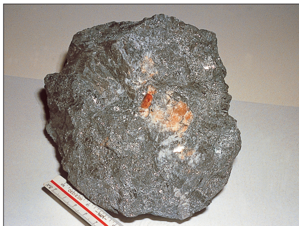
Foto 40. Muestra de mano en la que se observan cristales de scheelita (de color acaramelado) de 1 cm, junto con cuarzo blanco, rodeados por estibina laminar y granuda. Mina San Antonio (nº 88), Alburquerque (Badajoz).
