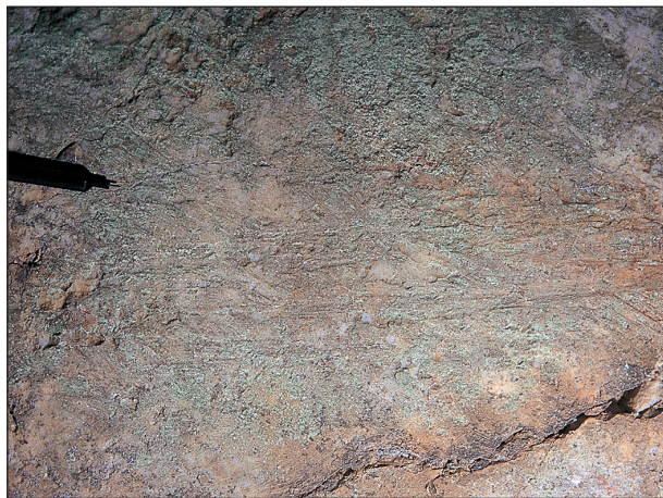
Foto 34. Fallas de orientación NNE-SSO ( N20^\circ E buzando 75^\circ O) con venas de cuarzo mineralizadas en oro del indicio La Portilla Larga (nº 72). Se reconocen varias generaciones de estrías (reactivaciones) en el plano de falla. Sector sur del Sinforme de La Codosera.
