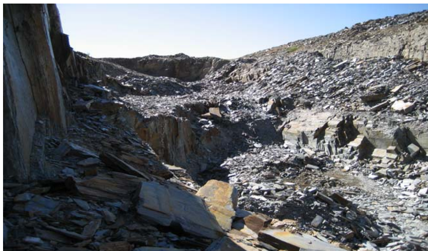
Figura 12.- Detalle del frente con las dos familias de diaclasado en la explotación “Las Primas” (Lucillo).
