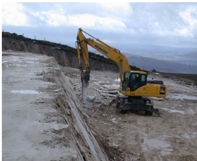
Figura 15.- Maquinaria extrayendo bloque primario en la cantera “Angelita 2ª fracción”.
