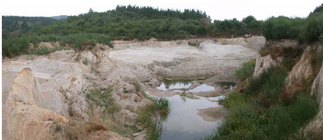
Figura 42.- Explotación “A Pallota” (Nº 355). Vista parcial de la cantera donde se explotan alteritas de granito con parte de la plaza de cantera inundada.
