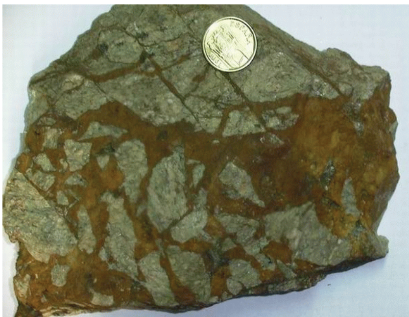
Foto 3.26. Mina Afortunada. Brecha hidrotermal cementada y soportada por ankerita. Los fragmentos muestran una intensa alteración potásica.
