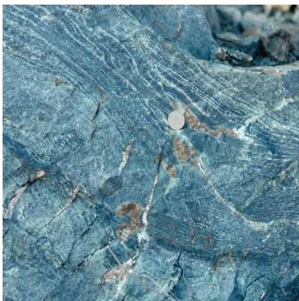
Foto 3.23. La Berrona. Mineralización bandeada de actinolita-albita-magnetita.
