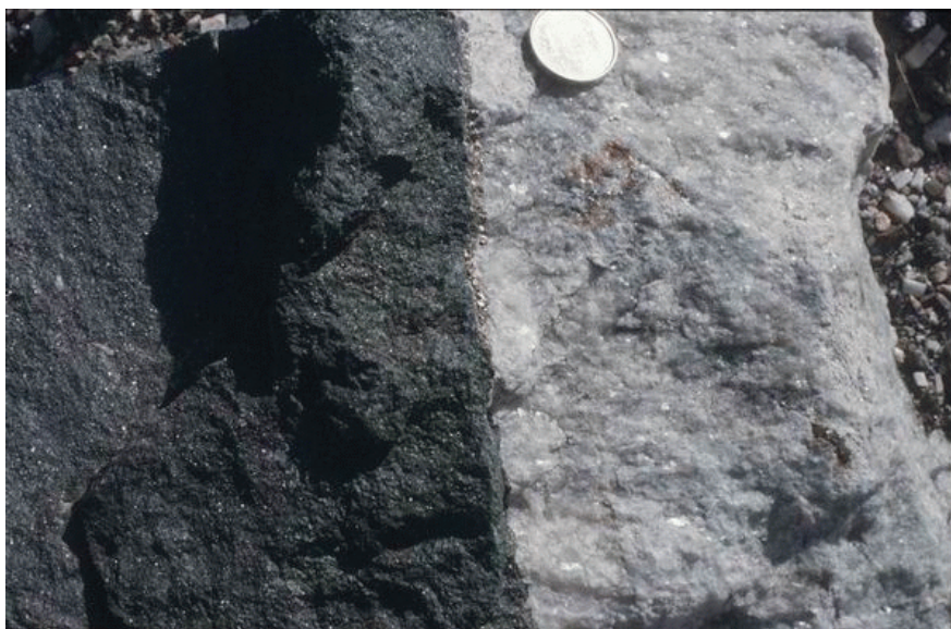
Foto 3.17. Mina El Castillo. Remplazamiento de mármol por magnetita masiva.
