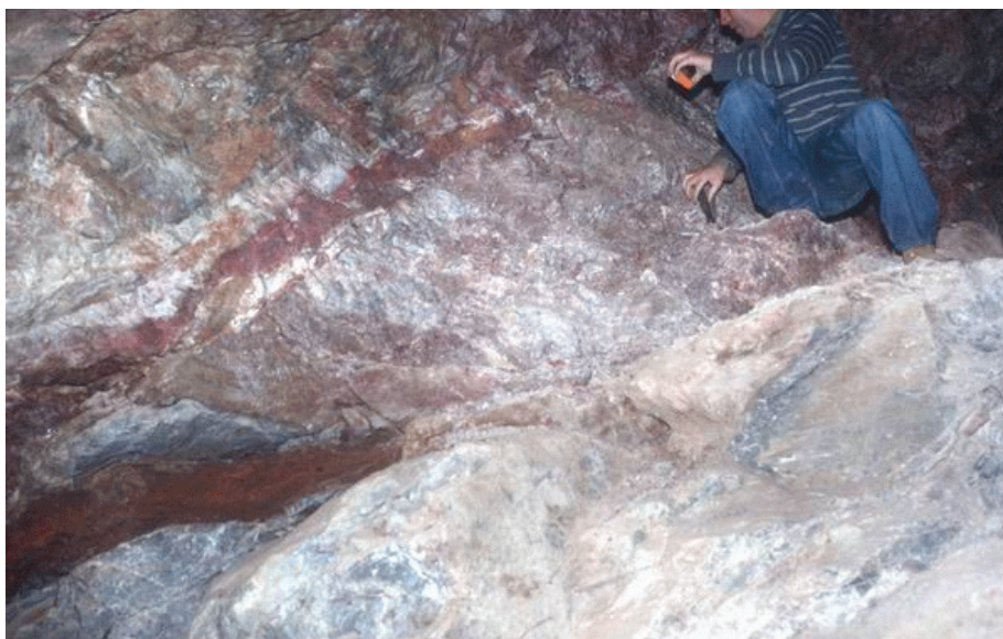
Foto 3.37. Mina La Sultana, Usagre. Zonas de remplazamiento de cinabrio en barita y caliza silicificada.
