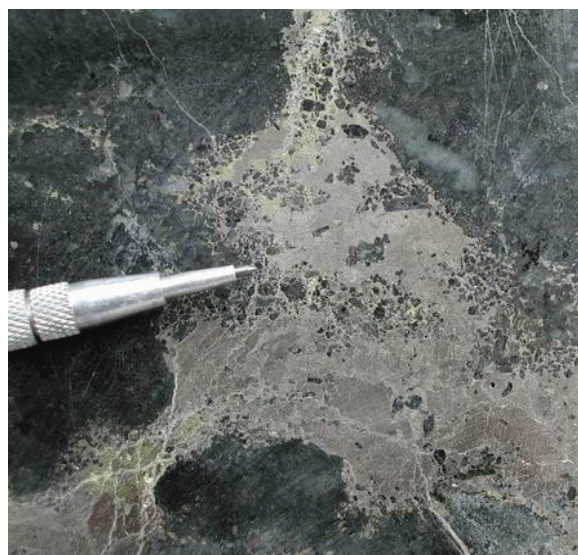
Foto 3.30. Aguablanca. Aspecto de la brecha mineralizada con fragmentos de piroxenita cementados por un magma inmiscible de sulfuros masivos y gabronorita.
