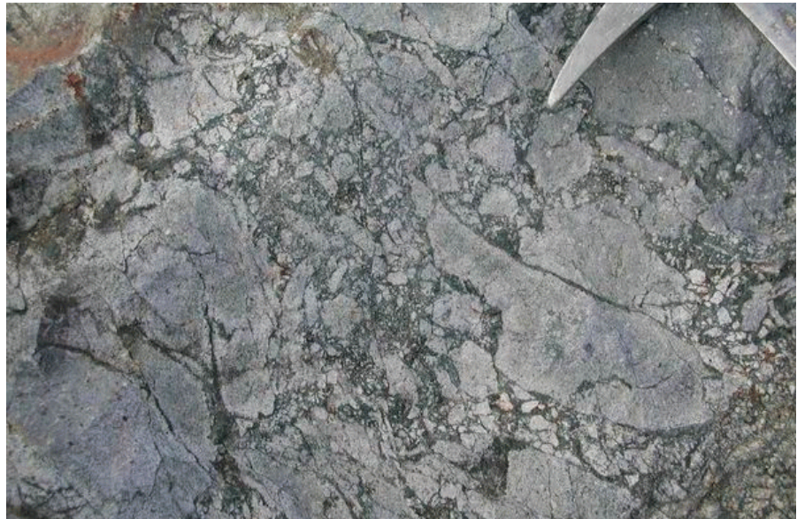
Foto 3.22. La Berrona. Brecha hidrotermal de actinolita-albita soportando una albitita masiva.
