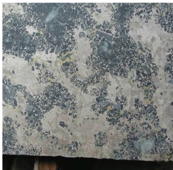
Foto 3.31. Aguablanca. Aspecto de sulfuros semimasivos con zonas elipsoidales enriquecidas en pirrotina, calcopirita y pentlandita rodeadas por otras en las que grandes cristales de piroxeno están soportados por sulfuros.
