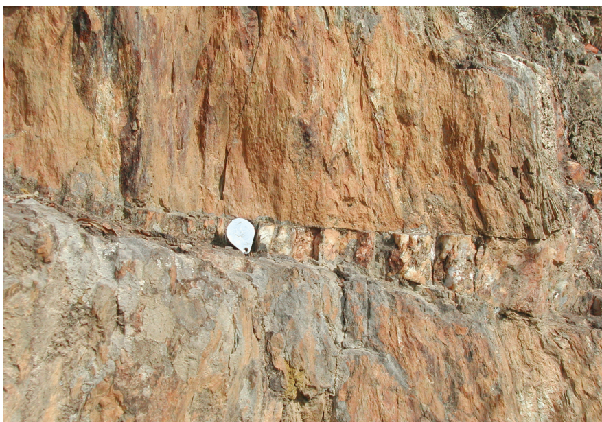
Foto 3.5. Mina Pilar. Filón de cuarzo con estibina en pizarra del Neoproterozoico.
