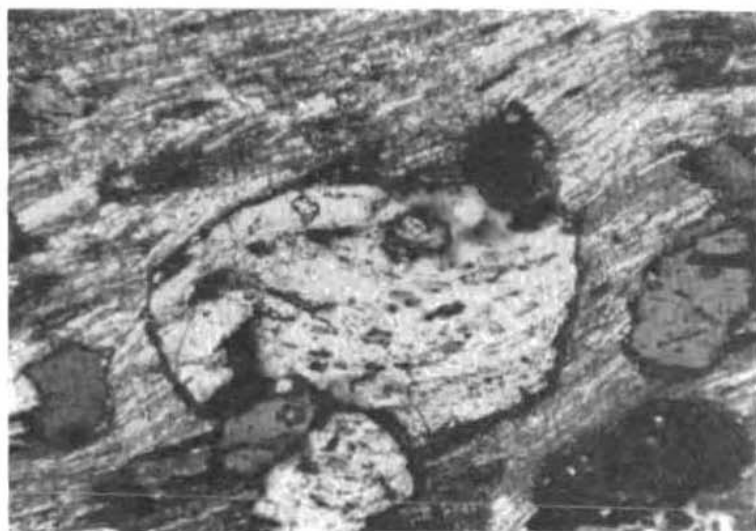
Microfotografía 2.—Porfidoblasto de albita con estructura rotacional. Sintecónico con la fase II. Esquistos Infraordovícos. Km. 16 carretera de Silleda a Carballino. (Nicoles cruzados, \times 145 .)
