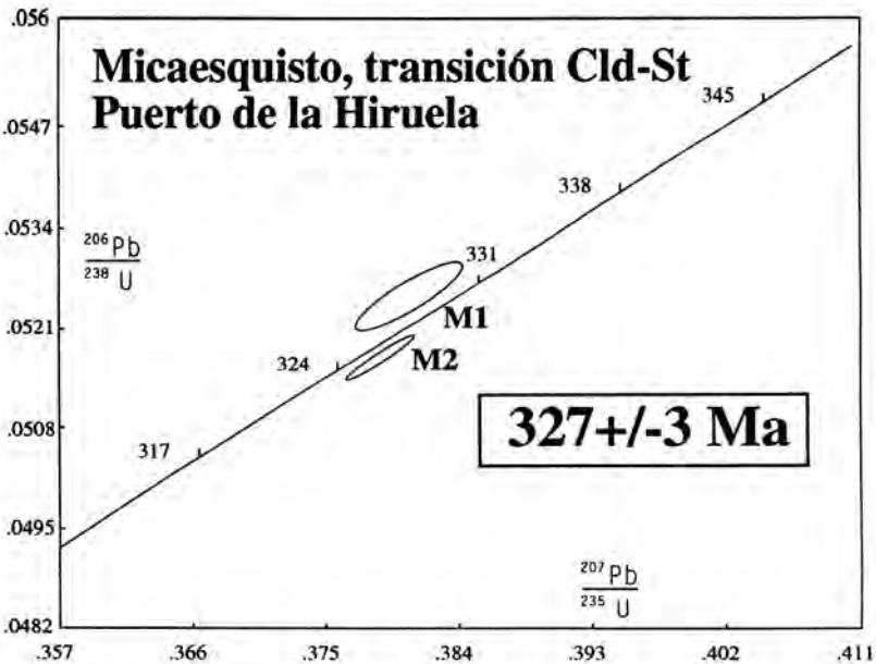
Figura 2.8. Diagrama de concordia para U-Pb de una muestra de micaesquisto en el P o de la Hiruela, en la transición cloritoide-estauroлита (hoja de Tamajón).
