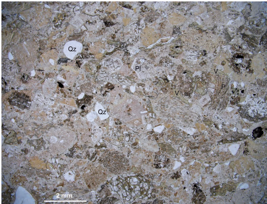
Figura 3.6.- Fotomicrografía representativa de un tuff constituido por fragmentos de rocas volcánicas de tamaño inferior a 2 mm ( lithic tuff ). De los diferentes fragmentos se señalan en la fotomicrografía cristales de cuarzo (Qz) y plagioclasa (Pl), algunos fragmentos de vidrio volcánico cloritizado (V) y un fragmento de pumita (P) en una sección donde se conservan vestigios de las vesículas en sección longitudinal (tubos). Nícoles paralelos.
