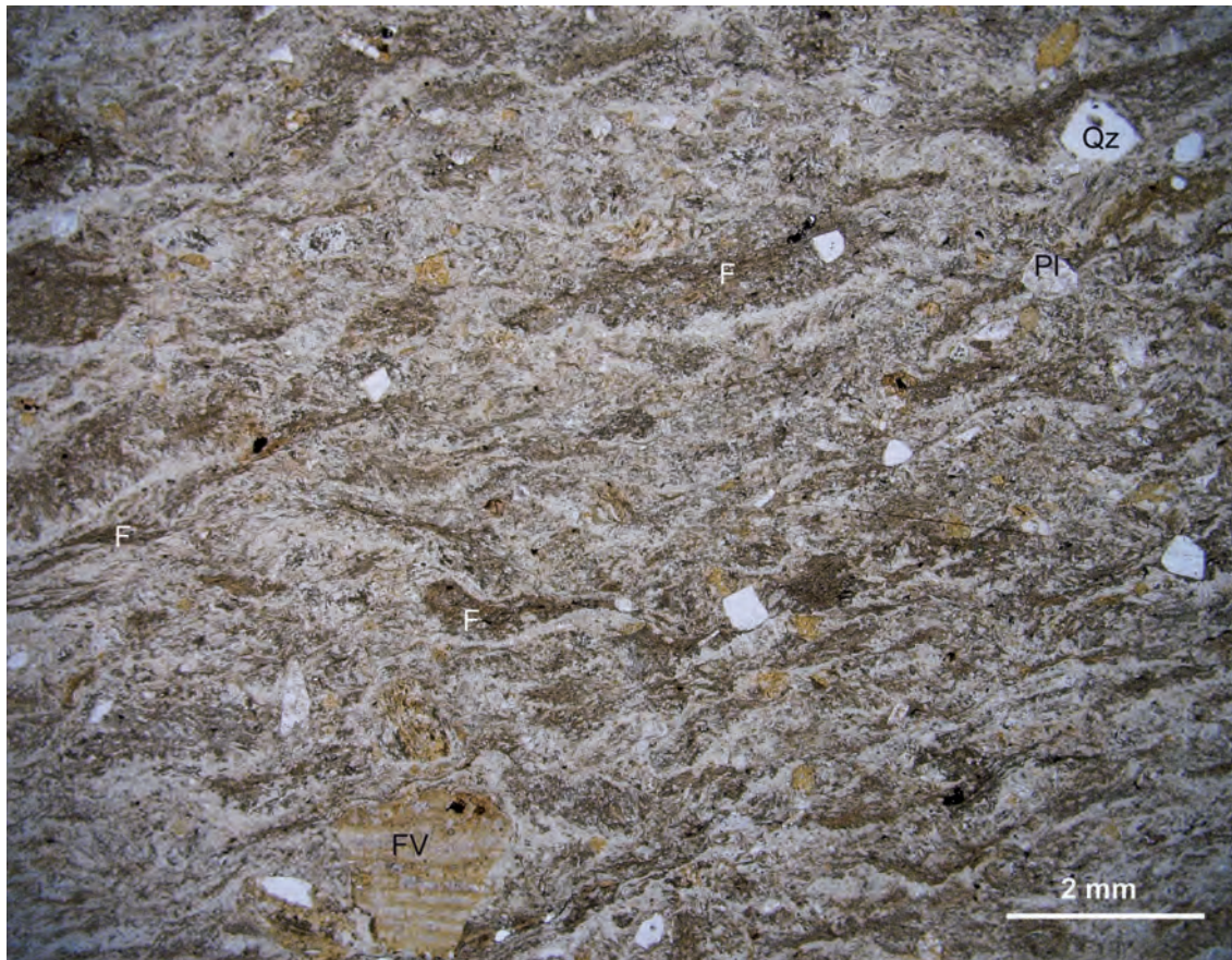
Figura 3.8.- Fotomicrografía de una ignimbrita con textura eutaxítica debido a la orientación paralela de piroclastos juveniles de vidrio desvitrificados a clorita (F). En la matriz micro-criptocristalina destacan cristales de cuarzo (Qz) y plagioclasa (Pl) y algunos fragmentos volcánicos (FV) constituidos por agregados microcristalinos de feldespato potásico ± cuarzo. Nícoles paralelos.
