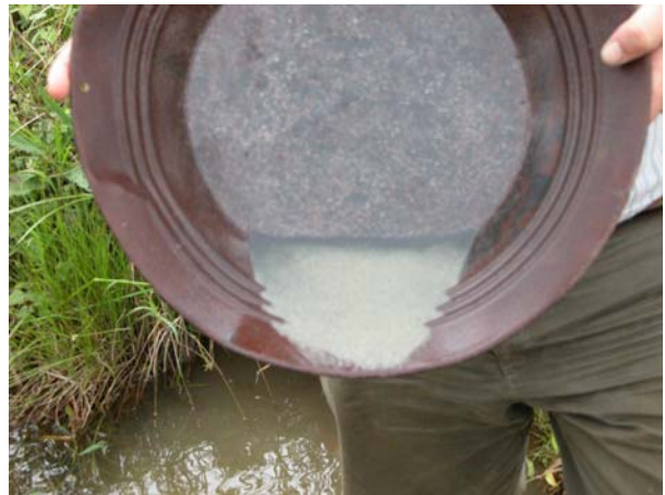
Foto 7-6. Fase final del bateado. Franja oscura de minerales pesados concentrados en la parte superior
