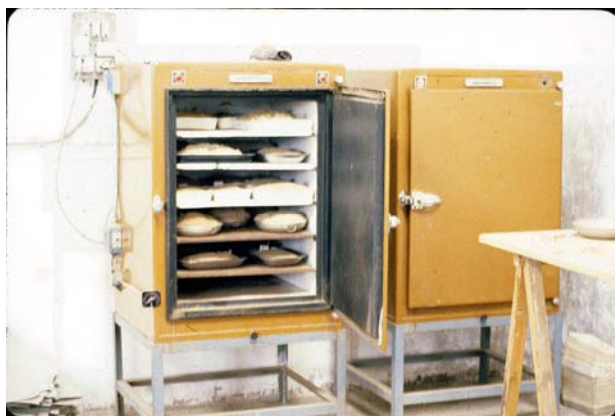
Foto 6-13. Secado de las muestras en estufas con temperatura controlada
