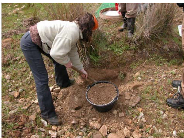
Foto 6-5. Toma de sedimento en cauce seco
