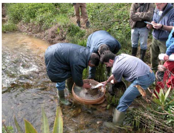
Foto 7-2. Cribado a 5 mm del sedimento para concentrado de minerales pesados
