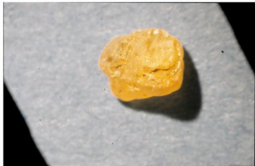
Foto 7-22. Grano de scheelita. M-1106. 50 aumentos
