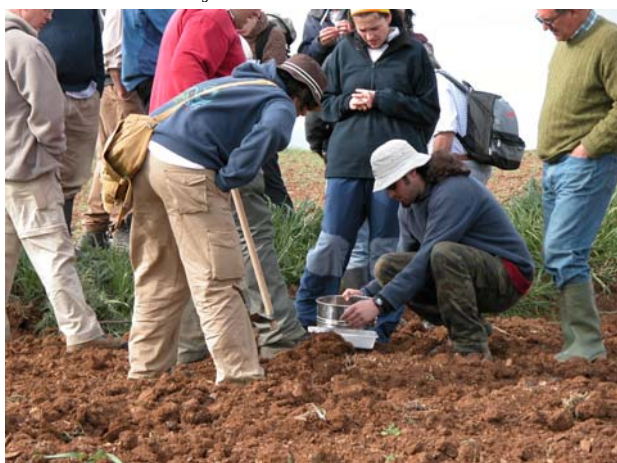
Foto 6-11. Tamizado en seco de una muestra de suelo durante la fase de formación de prospectores
