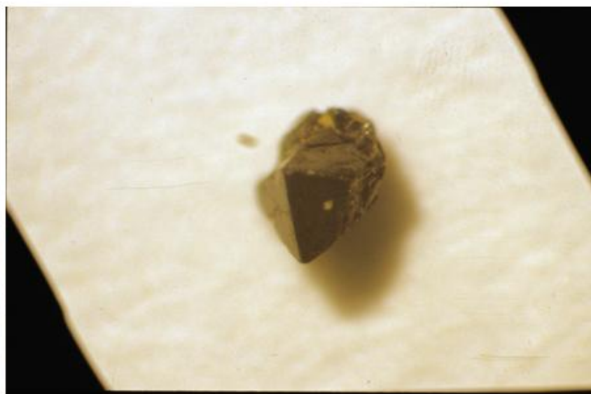
Foto 7-16. Grano de casiterita negra con pico de estaño. 50 aumentos. M-5371
