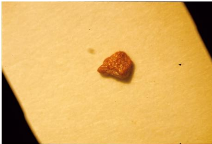
Foto 7-9. Grano de cinabrio bajo la lupa binocular (M-5793)- 50 aumentos
