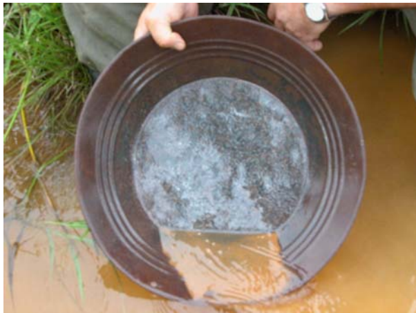
Foto 7-5. Apurando el bateado. Se empieza a ver una franja de minerales pesados (parte superior)
