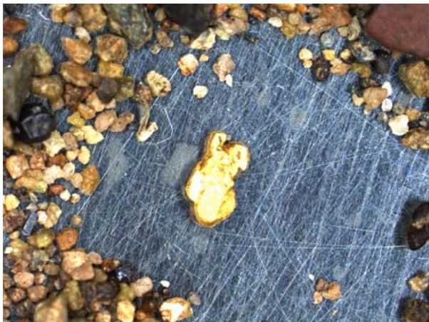
Foto 7.35. Fotomicrografía de un grano de oro nativo en el concentrado de la muestra 8540. (Lupa binocular. 40 aumentos)
