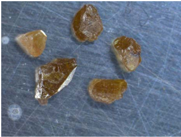
Foto 7.31. Fotomicrografía de granos de epidota en un concentrado (Lupa binocular. 60 aumentos)
