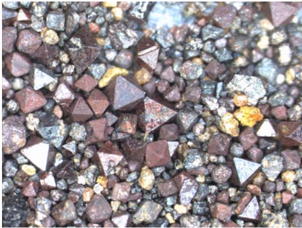
Foto 7.25. Fotomicrografía de granos octaédricos idiomorfos de magnetita (Lupa binocular. 50 aumentos)
