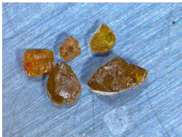
Foto 7.14. Fotomicrografía de granos de esfalerita acaramelada (Lupa binocular. 50 aumentos)
