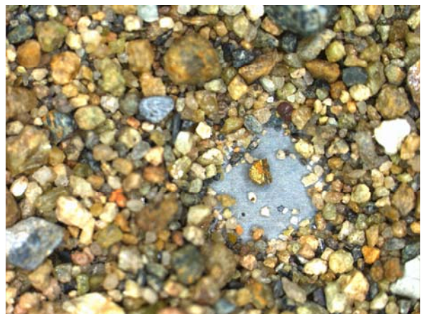
Foto 7.36. Fotomicrografía de un grano de oro poco rodado en el concentrado de la muestra 8594)
