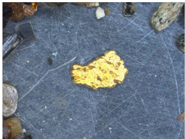
Foto 7.34. Fotomicrografía de un grano de oro nativo en un concentrado. Muestra 8540 (Lupa binocular. 40 aumentos)
