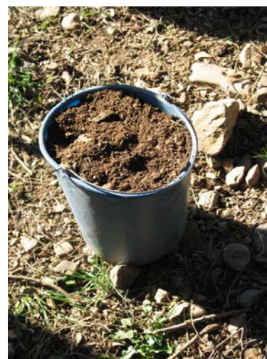
Foto 7.2. Muestra heterogranular de 10 litros de sedimento sin tamizar
