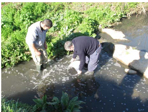
Foto 7.5. Operación de bateado y de obtención del concentrado con pan californiano
