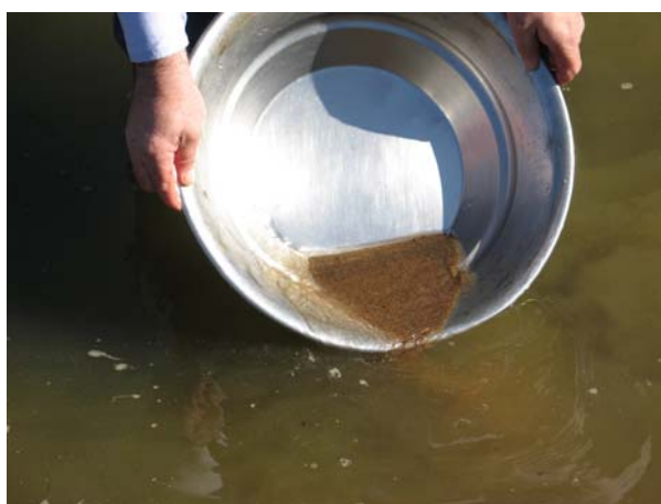
Foto 7.6. Obtención del concentrado y operación de afino del lavado. Se ven ya franjas oscuras de minerales pesados en la parte superior.
