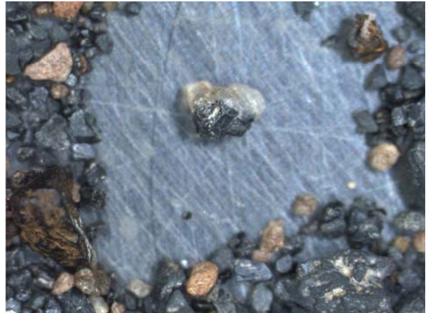
Foto 7.30. Fotomicrografía de un cristal de ilmenita implantado en cuarzo (Lupa binocular. 40 aumentos).
