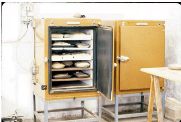
Foto 6.11. Secado de las muestras en estufas con temperatura controlada. Litoteca IGME
