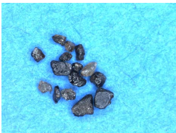
Foto 7.15. Foto micrografía de granos de casiterita (Lupa binocular. 40 aumentos)
