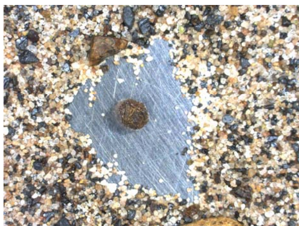
Foto 7.16. Fotomicrografía de un granate con su típico hábito (lupa binocular. 25 aumentos)
