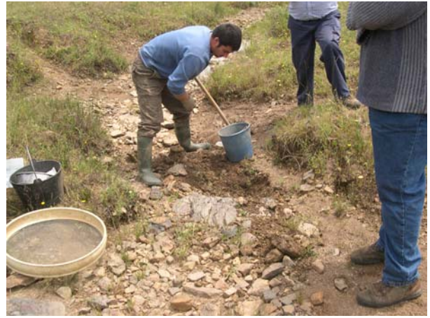
Figura 6.2. Toma de un incremento de muestra de sedimento en el mismo punto que la anterior. Obsérvese la granulometría del depósito.
