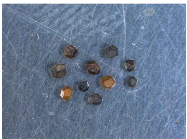
Foto 7.18. Fotomicrografía de varios granos de pirita con cristalización dodecaédrica y oxidadas (Lupa binocular. 40 aumentos)
