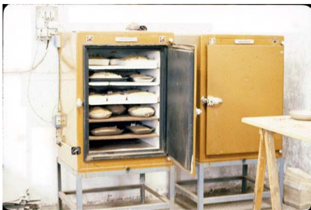
Foto 6.11. Secado de las muestras en estufas con temperatura controlada. Litoteca del IGME
