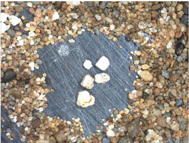
Foto 7.27. Fotomicrografía de granos de Berilo y/o crisoberilo en un concentrado (Lupa binocular. 40 aumentos)
