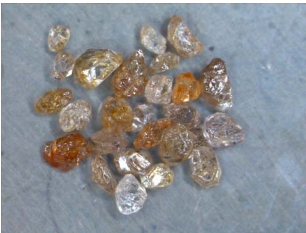
Foto 7.9. Fotomicrografía de unos granos de circón en el concentrado (Lupa binocular. 50 aumentos)
