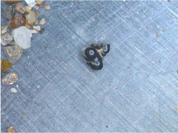
Foto 7.13. Fotomicrografía de un grano de goethita con estructura coloforme (Lupa binocular. 50 aumentos)
