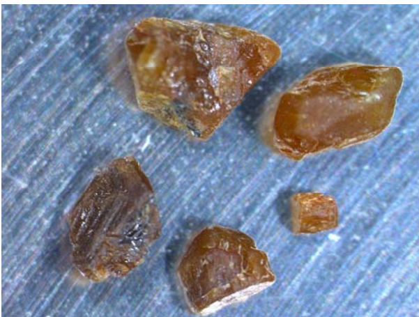
Foto 7.11. Fotomicrografía de granos redondeados de estaurólita (Lupa binocular. 60 aumentos)
