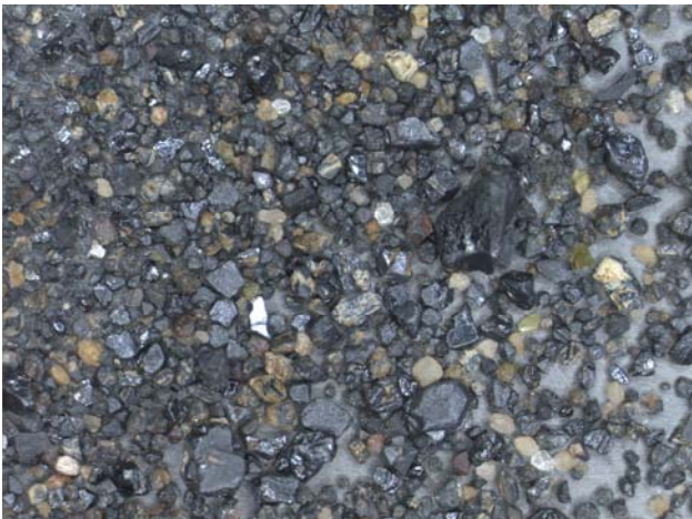
Foto 7.23. Fotomicrografía de un concentrado muy rico en granos de hematites (Lupa binocular. 40 aumentos grano)
