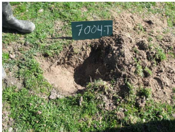
Foto 6.8. Pocillo realizado en el centro de un esquema en cruz para la toma de una muestra compuesta de suelo residual. Zona de Fregenal.
