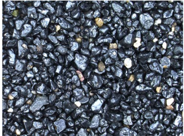
Foto 7.22. Fotomicrografía de concentrado rico en ilmenita, con granos con hábitos cristalinos y otros rodados (Lupa binocular. 40 aumentos)
