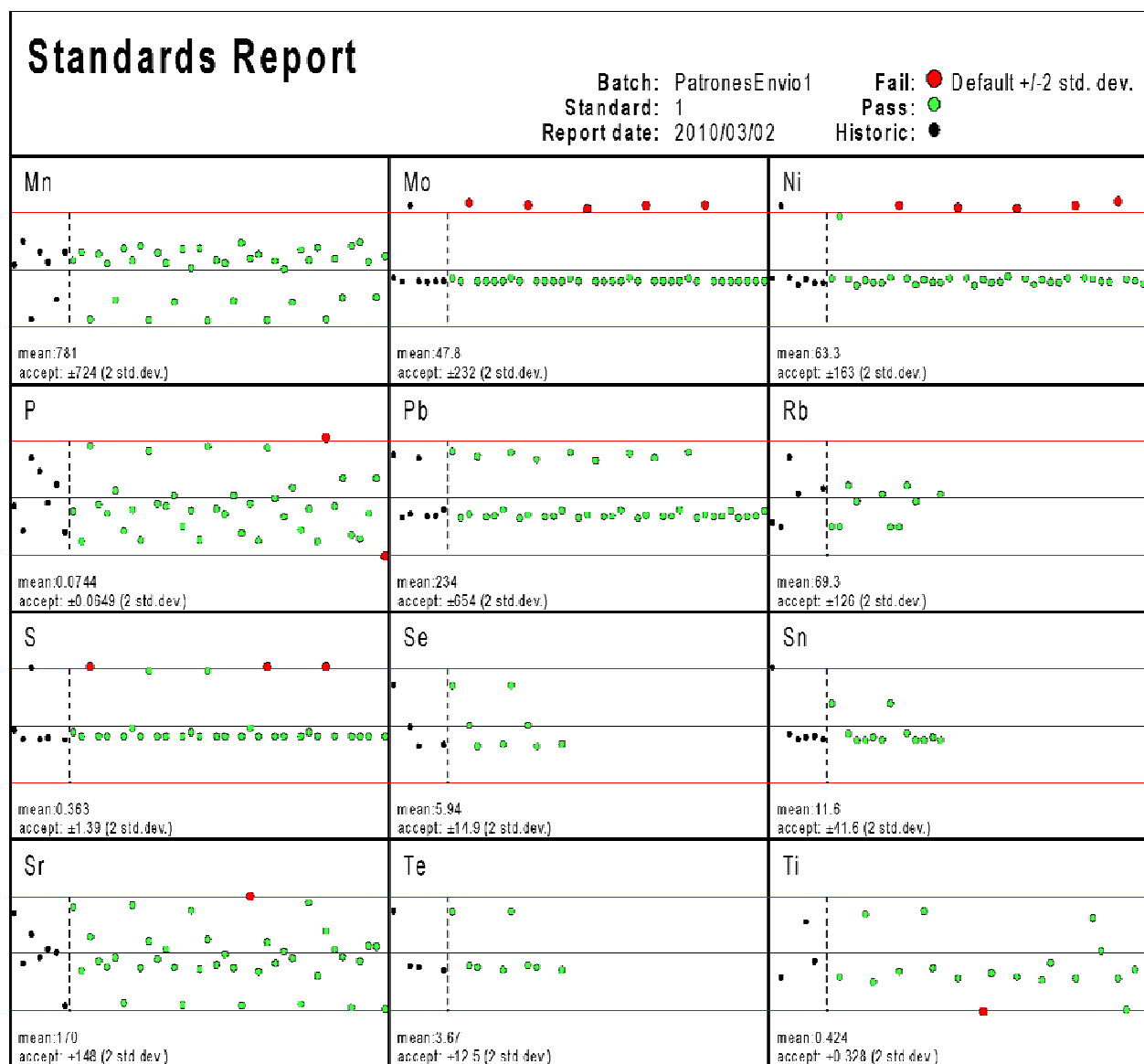
Figura 6.6. Resultados de control de exactitud con patrones internacionales de la muestras del envío n° 1, para los elementos de Mn a Ti.
