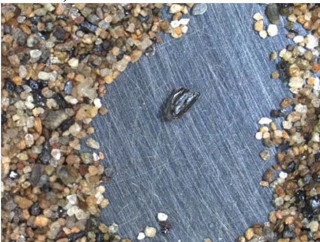
Foto 7.29. Fotomicrografía de un grano de rutilo (Lupa binocular. 30 aumentos)
