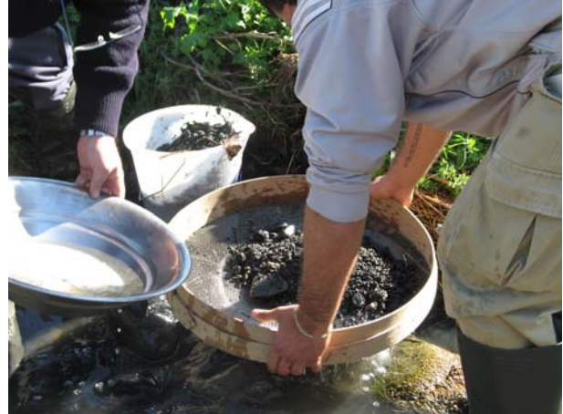
Foto 7.4. Operación de tamizado de la muestra de sedimento por vía húmeda
