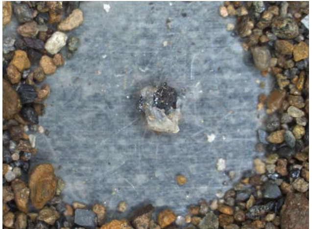
Foto 7.24. Fotomicrografía de un grano muy poco rodado de cuarzo con implante de un cristal de wolframita (Lupa binocular. 50 aumentos)
