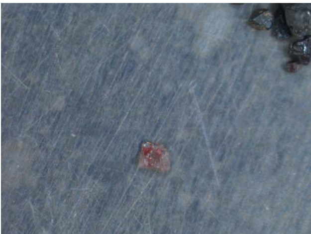
Foto 7.17. Fotomicrografía de un grano de cinabrio. (Lupa binocular. 40 aumentos)
