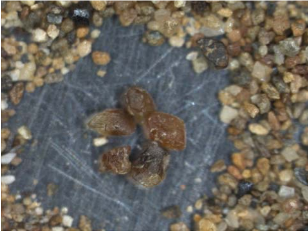
Foto 7.19. Foto micrografía de varios granos de casiterita semitransparente (Lupa binocular. 50 aumentos)
