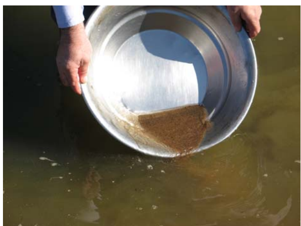
Foto 7.6. Obtención del concentrado y operación de afino del lavado. Se ven ya franjas oscuras de minerales pesados en la parte superior.
