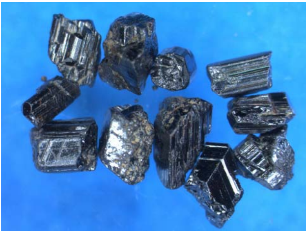
Foto 7.21. Fotomicrografía de cristales de ilmenita, estriados y alguno con maclas (Lupa binocular. 50 aumentos)
