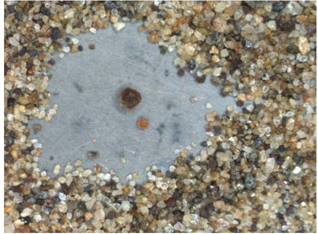
Foto 7.20. Fotomicrografía de granods de granate, uno de ellos rojizo (Lupa binocular. 40 aumentos)
