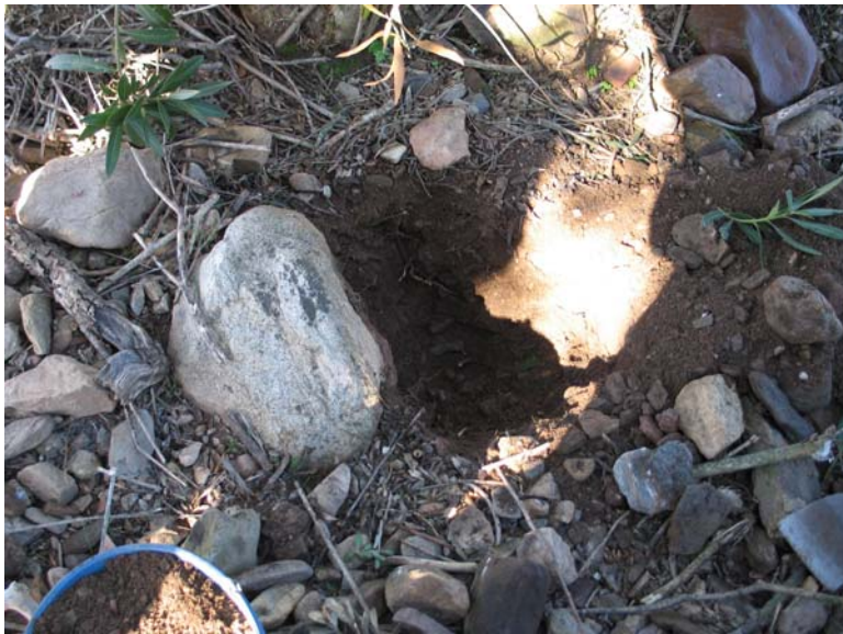
Foto 7.1. Pocillo en arroyo seco para la toma de muestra del concentrado de minerales pesados
