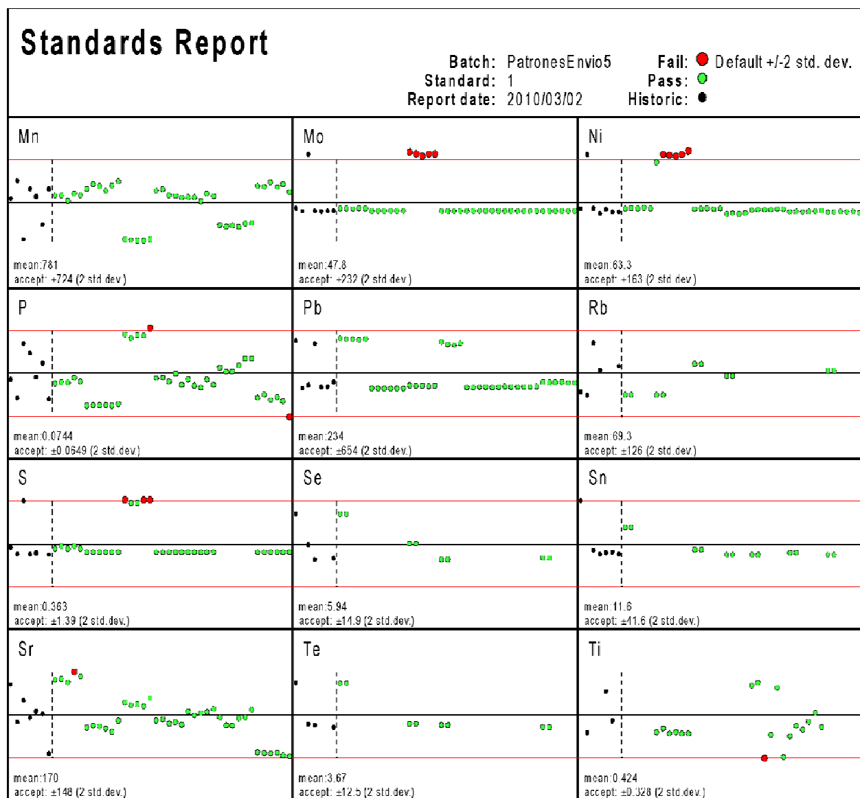
Figura 6.9. Resultados de control de exactitud con patrones internacionales de la muestras del envío n° 5, `para los elementos de Mn a Ti.
