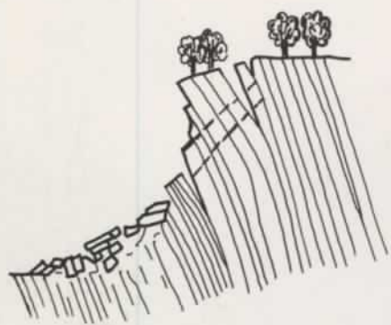
Vuelco por flexión de un talud rocoso
