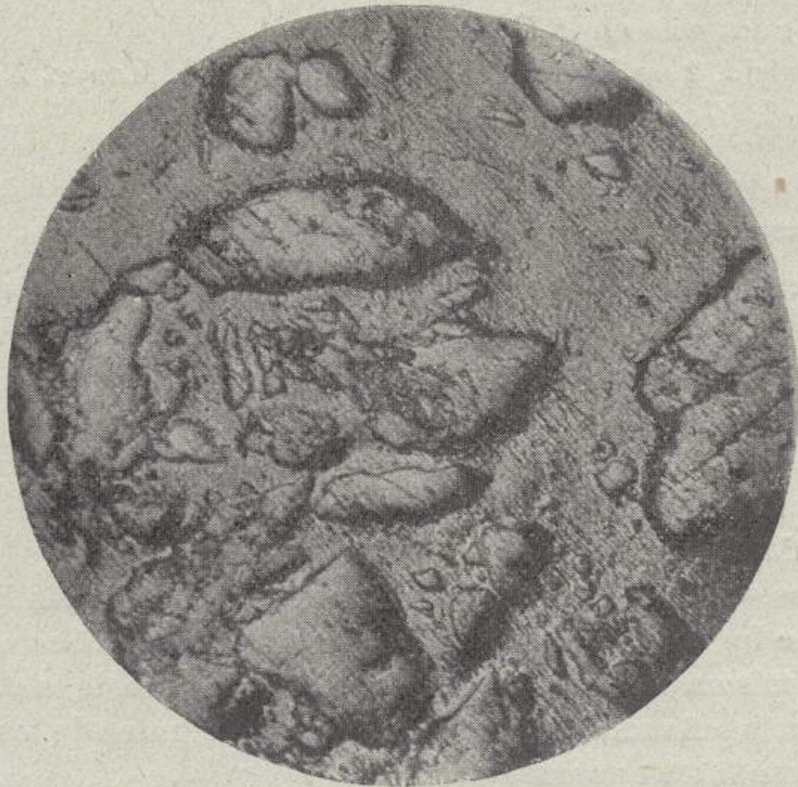
Microfotografía de la fracción de un carbón de cok, de densidad menor de 1,30. Granos de vitreno, sin restos vegetales y con inclusiones de hidrocarburos y resinas. Microscopio metalográfico.
