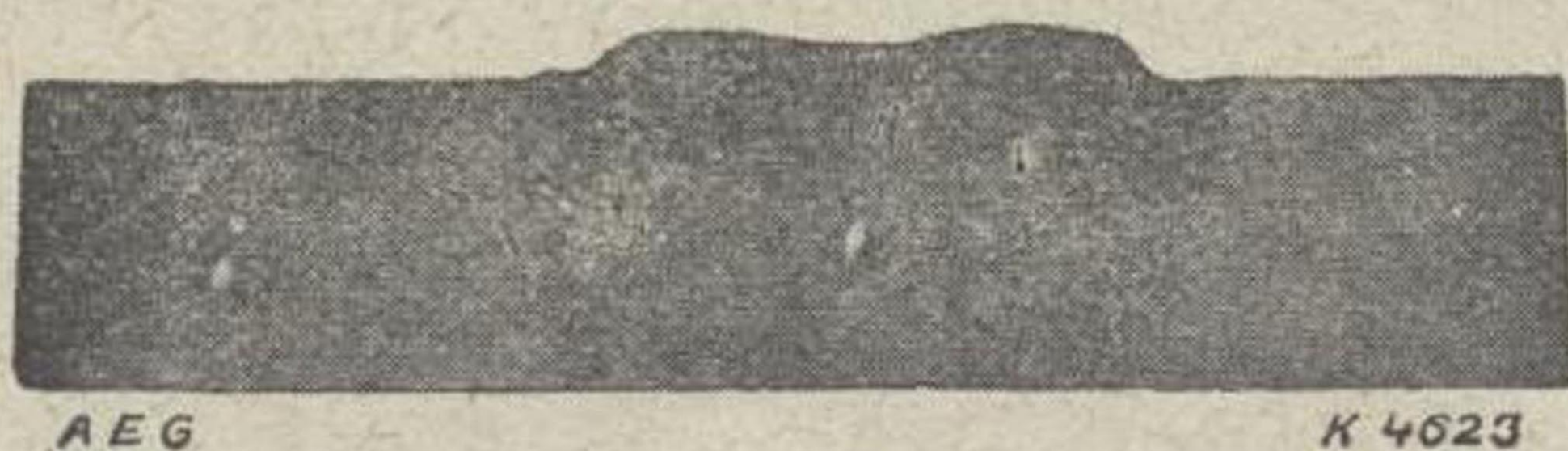
Fig. 22.—Sección pulimentada de una buena soldadura en caliente.
