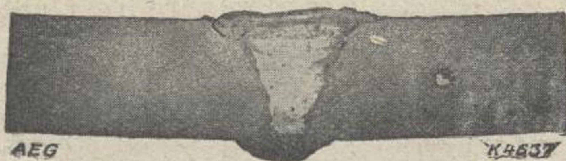
Fig. 23.—Sección pulimentada de una soldadura de hierro fundido en frío.
