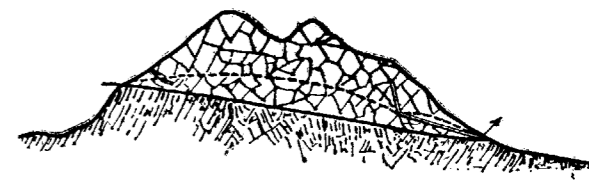
Fig. 11. Aljibe natural en roca cavernosa. (Si la salida artificial ó natural por G es menor que el aporte anual pluviométrico, el manantial será permanente; si mayor, será inconstante.)
