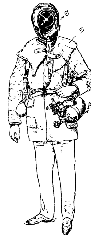
Obrero equipado para salvamento.—A, aparato Wanz.—J, casco Mayer.—S, saco-esclavina para el aire.
