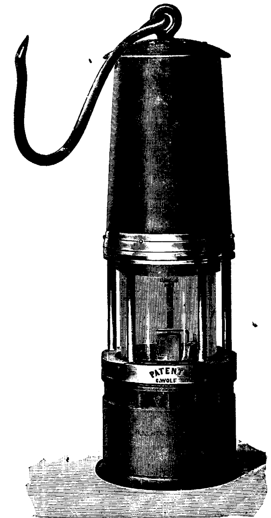
Fig. 1.ª - Lámpara de seguridad Wolf con introducción de aire por debajo, encendedor por fricción y cierre magnético.
