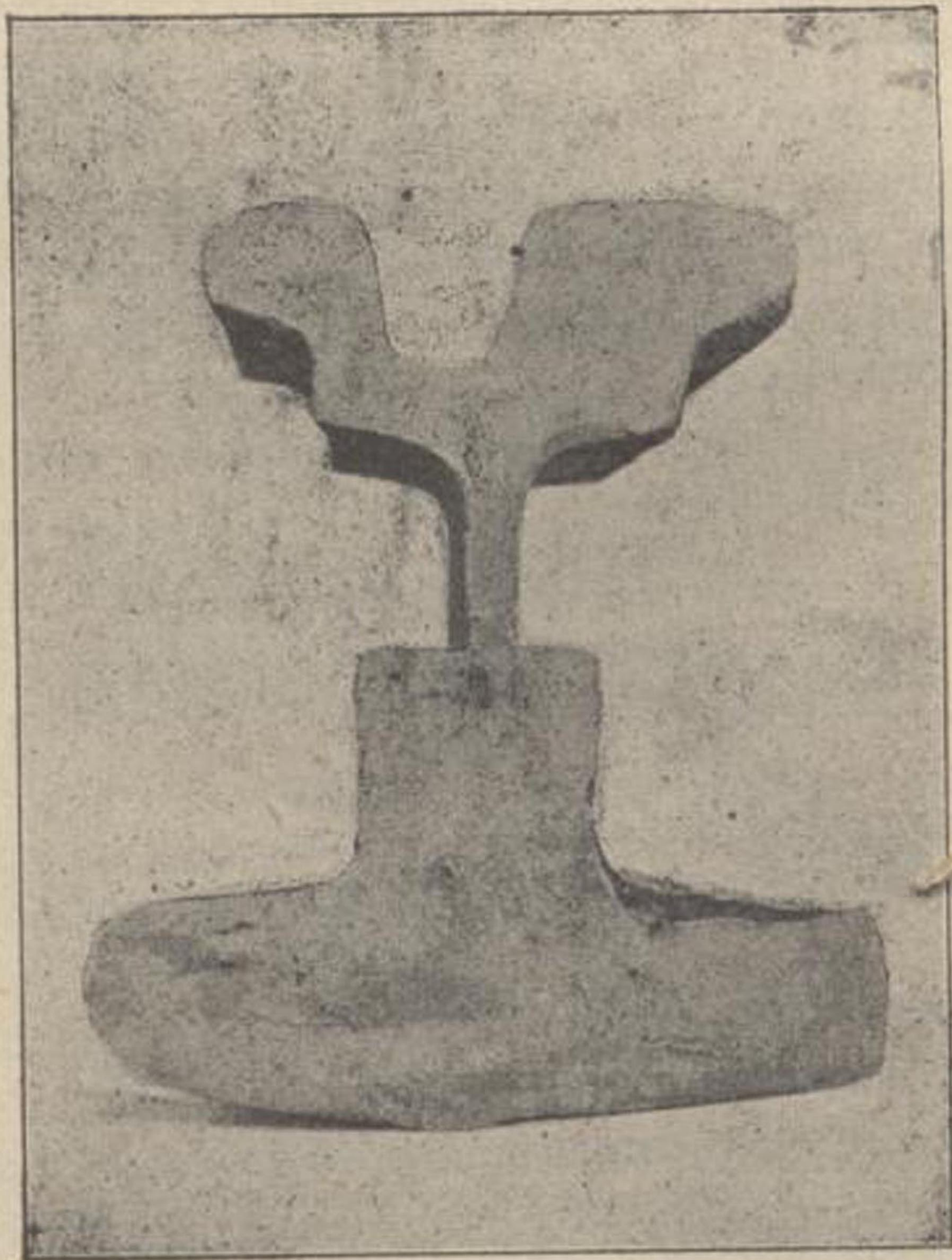
Fig. 4. o — Soldadura de carriles. — Corte de una soldadura hecha en un carril, alrededor de cuyo patin se ha colado una eclisa de hierro á la termita. Después de atacar la sección por medio de un ácido, no se ve más que una pequeña parte del perfil del rail.
