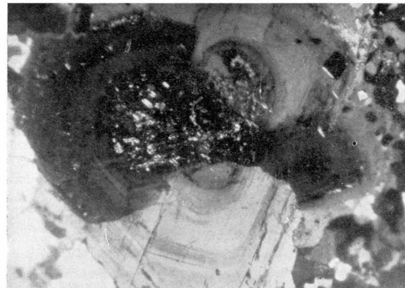
Fot. 3.—Cristales idiomórficos de plagioclasas zonadas con núcleos alterados pertenecientes al granito 1-L de Linares. N X; 35 D.
