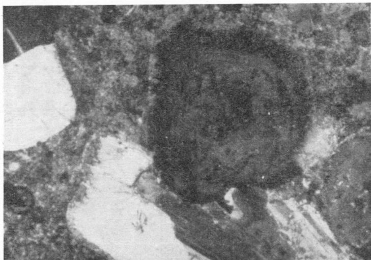
Fot. 4.—Textura porfidoblástica del pórfido B; cristales de plagioclase, uno de ellos zonado, alterados a sericita en sus bordes. N X; 35 D.
