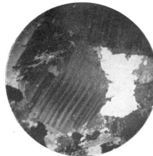
Fot. 7.—40 aumentos. N+. Cuña de cuarzo rompiendo a la plagioclasa huésped de las inclusiones. Obsérvese ligera ondulación de los planos de unión.
