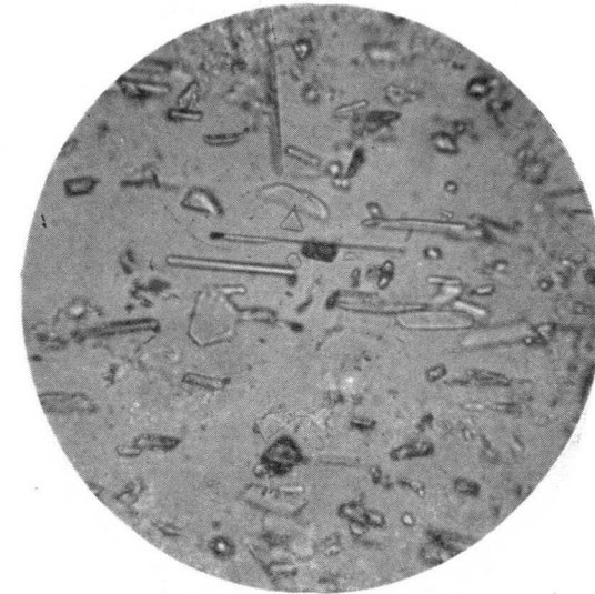
Fot. 13.—320 aumentos. N=. Secciones idiomórficas de las inclusiones.
