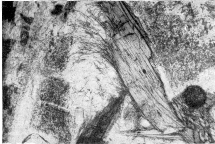
Fot. 5.—Un caso similar al de la foto anterior, en el que quedan finas agujas del anfíbol dentro de la calcita. Tanto en el ángulo superior derecho como en el izquierdo quedan las plagioclasas muy alteradas. L. N., 35 D.
