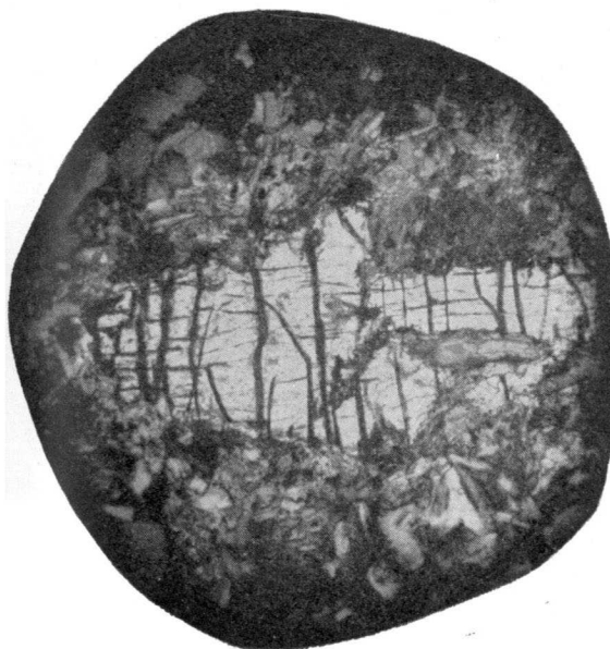
Fig. 76.—Espesartita. 80 aumentos. N=. Olivino con grietas serpentinizadas y aureola piribólica.
