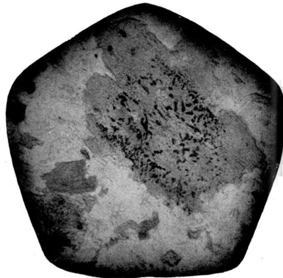
Fig. 67.—Espesartita. 80 aumentos. N=. Biotita con granalla de magnetita.
