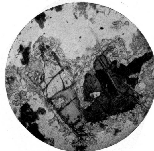
Fig. 57.—Lamprófido Mangerítico II. 80 aumentos. N+. Olivino con bordes de piróxeno y alteración clorítico-serpentina.
