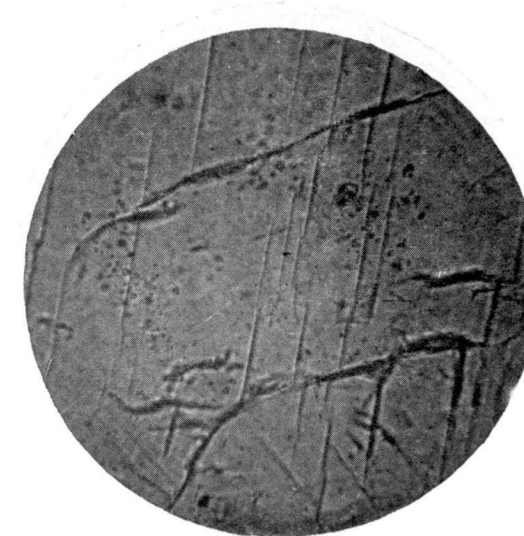
Fig. 47.—Lamprófidio Mangerítico II. 320 aumentos. N=. Estriaciones N-S, roturas y microfallas en una plagioclasa zonal.
