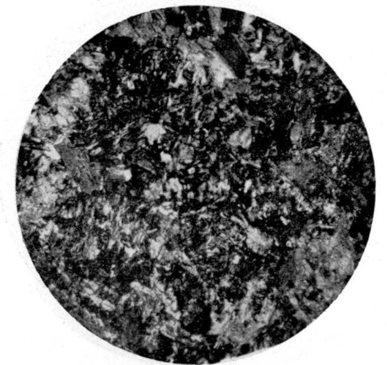
Fig. 41.—Lamprófidio Mangerítico I. Aumentos 80. N+. Cloritas bordeadas de calcita y flecos de biotita.
