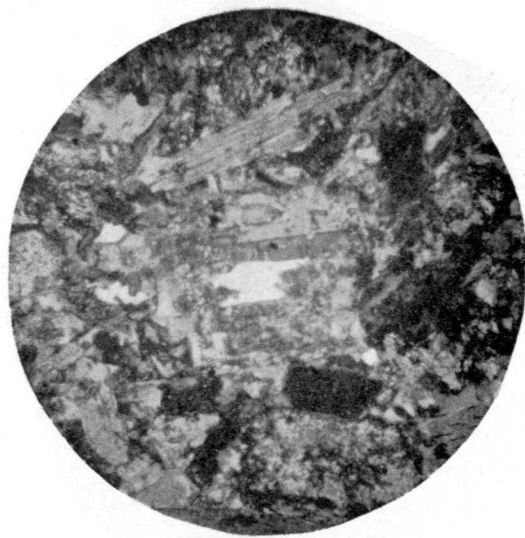
Fig. 36.—Lamprófidio Mangerítico I. 80 aumentos. N+. Plagioclasa emergiendo de la general alteración.
