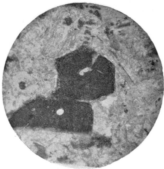
Fig. 42.—Lamprófidio Mangerítico I. 30 aumentos. N=. Biotitas idiomórficas teñidas de hidróxido férrico.
