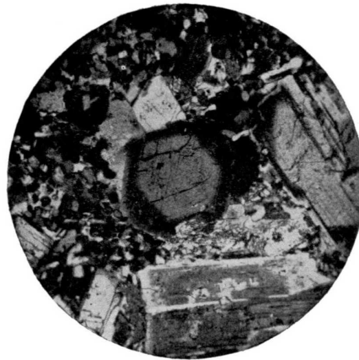
Fig. 49.—Lamprófidio Mangerítico II. 80 aumentos. N+. La misma plagioclasa a 17° izquierda de la N-S.
