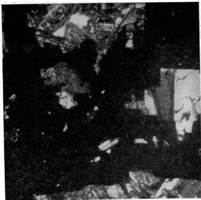
Fig. 15. —Detalle de la pirita con inclusiones de plagioclasa.
