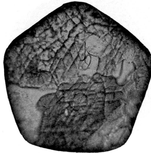
Fig. 73.— Espesartita. 320 aumentos. N=. Borde de piróxeno transformados en anfíbol.
