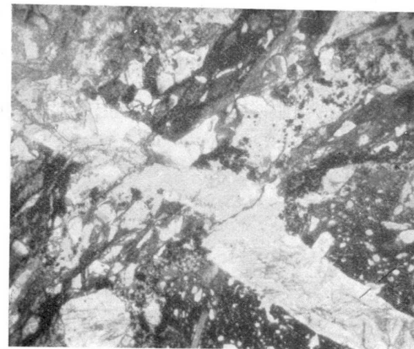
Fot. 5.—Filoncillos de carbonatos que cortan, en la parte izquierda inferior, un grano de roca efusiva. L. N. 30 D. aprox.
