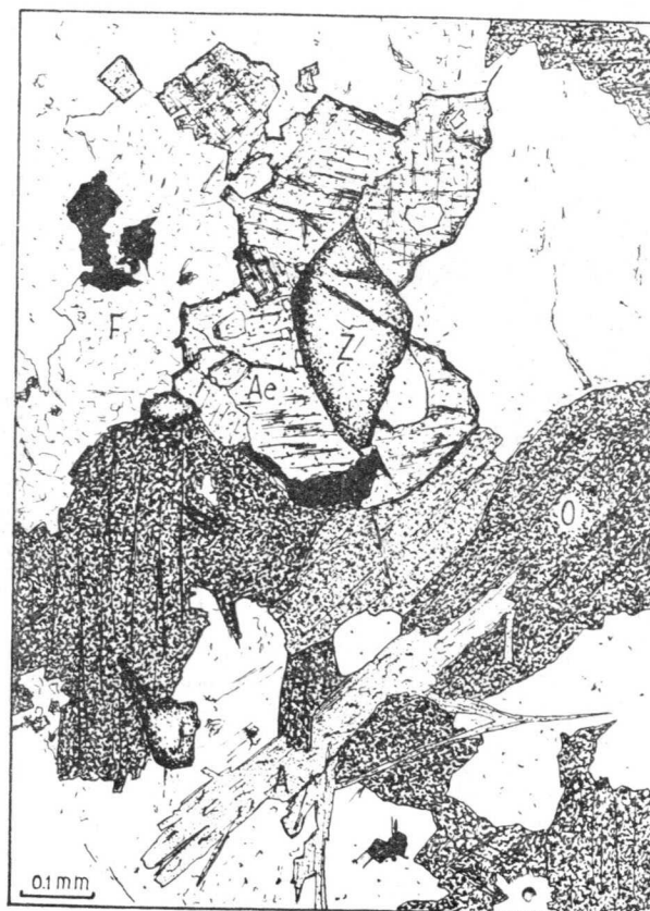
Fig. 3.—Astrofilita en gneis, O. de Zamanes. O: osanita; Ae: aegirina; A: astrofilita; Z: zircón; F: fluorita. Z: zircón; F: florita.
