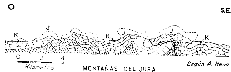
Fig. 2. Estratos plegados, y afectados por fallas cabalgantes, en las montañas del Jura.
