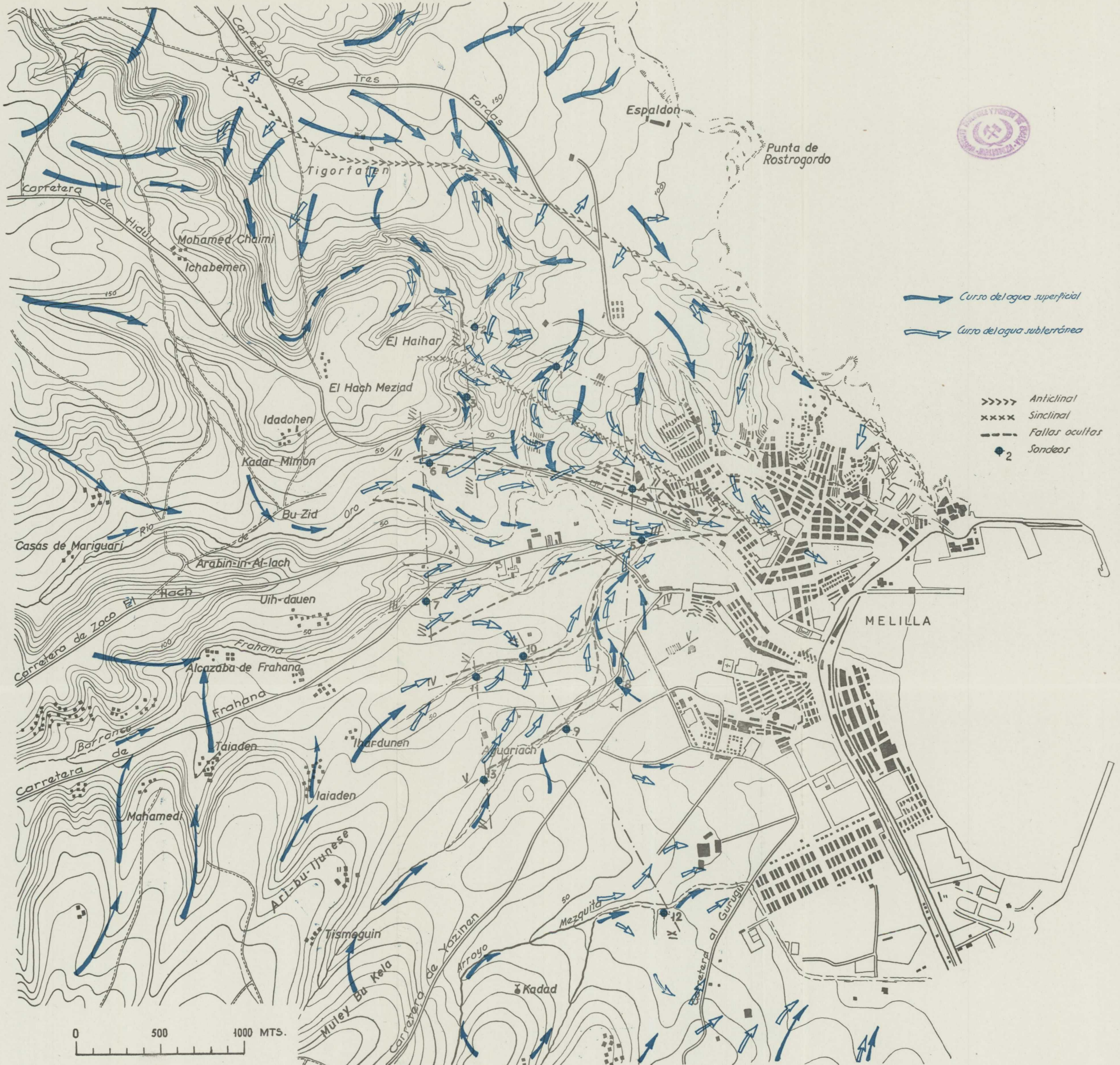
ALUMBRAMIENTO DE AGUAS EN LA ZONA DE MELILLA.—PLANO TOPOGRÁFICO.
