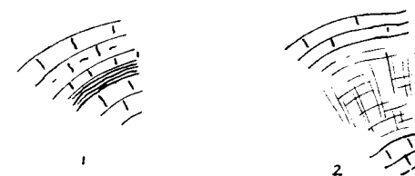
Fig. 6.—Esquistosidad en función de la potencia de los bancos. 1. Banco delgado de pizarra entre cabezas. Esquistosidad paralela a la estratificación. 2. Banco potente. Esquistosidad independiente de la estratificación.
