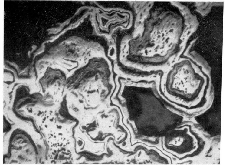
Fig. 9.—220 aumentos. Inmersión en aceite. Hierro acicular, recreci en forma de gel con goethita. Extinción de una capa, intensamente meteorizada, en el valle del río Castrillo.
