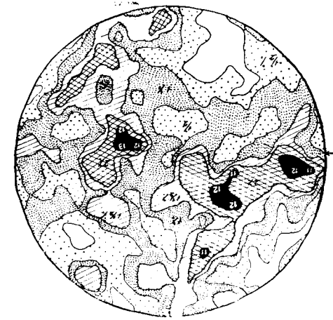
Diagrama 14 (M 29).—400 ejes ópticos de cuarzo de las ramas y la cresta del pliegue anterior (Sección B). Contornos 0.5 — 1 — 1.5 — 2 — 3 %. Máxima concentración, 3,25 %.
