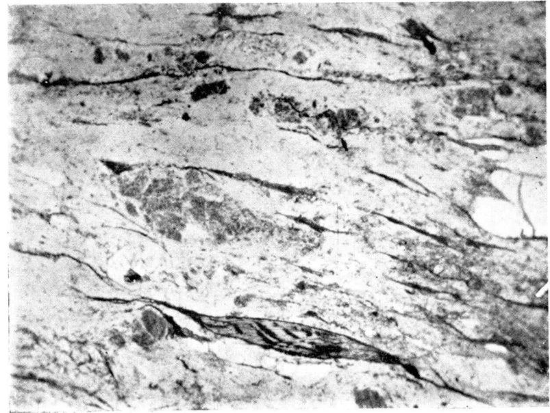
Fig. 2.—Lámina de biotita fusiforme y cristales de feldespatos alterados con la misma orientación e incluidos en una pasta felsítica. L. N. y 100 D. Pertenece a la A_2 .
