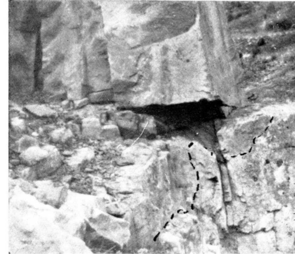
Fig. 1.—Fotografía del lugar donde se recogieron las muestras A_1 , C_4 , C_3 , C_2 y C_1 . El límite entre el pórfido y las calizas va indicado por una línea de trazos. Obsérvese las fracturas que presenta el pórfido.
