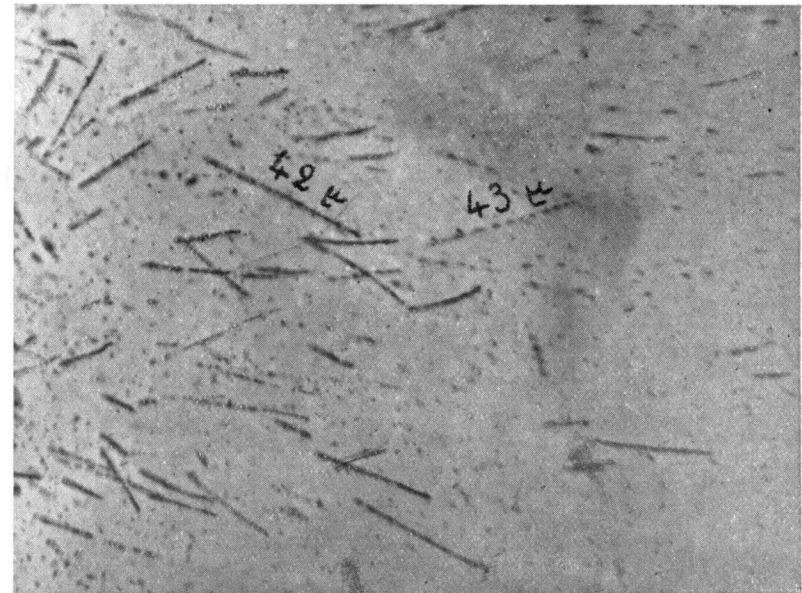
Foto 4.—Algunas trayectorias largas ( > 39 \mu ) permiten descubrir la presencia del ThC' y por consecuencia la del Th.
