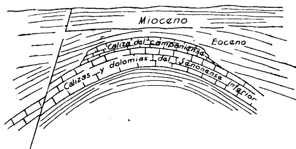
Corte transversal esquemático del anticlinal de Lacq.
