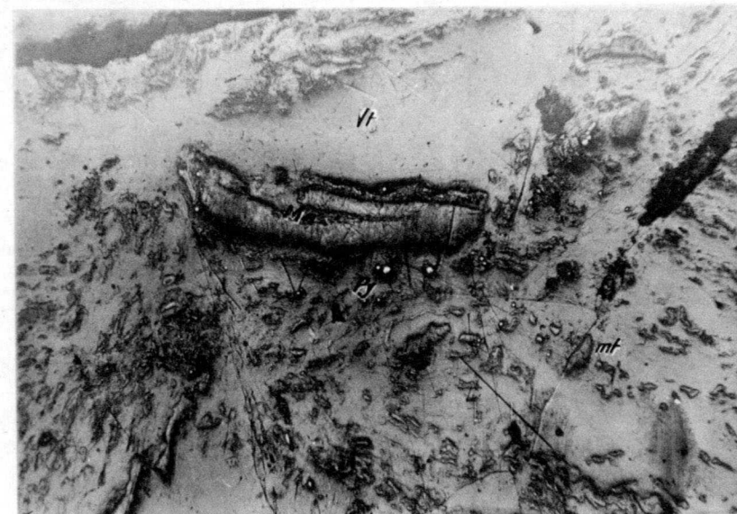
Supuesto esquisto al muro de la capa 41. \times 75 Clarita: Vt- pasta vitrítica: Me- macroespora: mt- microespora: Py- pirita
