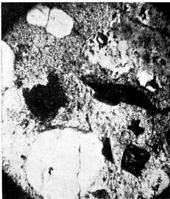
Figs. 3 y 4. — Pórfido granítico del Coll del Bosch. L. ord. y N. 25 d. Fenocristales de cuarzo, de oligoclasa, ortosa y biotita, sobre pasta microgranada de igual composición.
