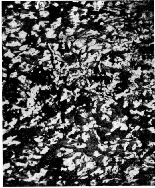
Fig. 16. — Cornubianita cuarzomicaea de la Fou. L. ord. 25 d. Maso homogranoblástica de cuarzo y de biotita.
