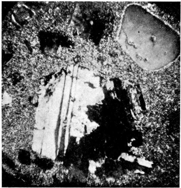
Figs. 3 y 4. — Pórfido granítico del Coll del Bosch. L. ord. y N. 25 d. Fenocristales de cuarzo, de oligoclasa, ortosa y biotita, sobre pasta microgranada de igual composición.
