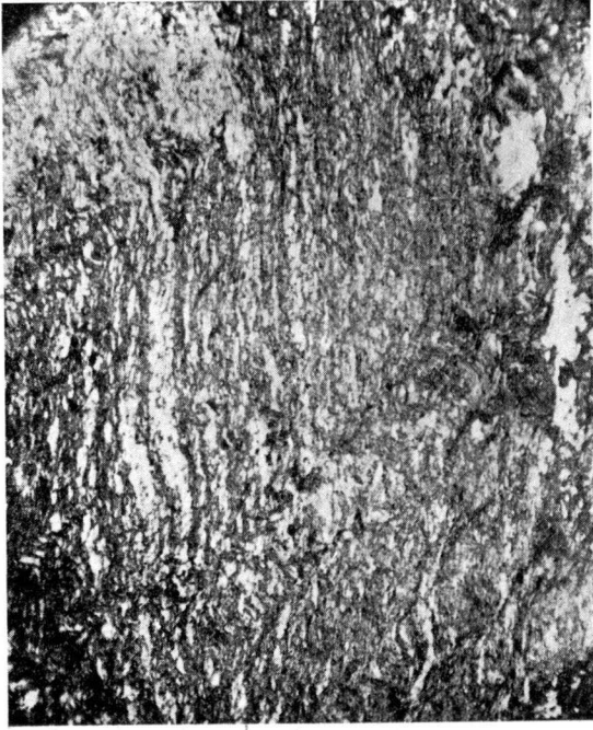
Fig. 15. — Micacita andalucítica replegada de Vallbona. L. ord. Estructura granoblástica paralela, con capas de cuarzo, moscovita y biotita, y otras ricas en andalucita. Sobre éstas destacan algunos pórfidoblastos de andalucita.
