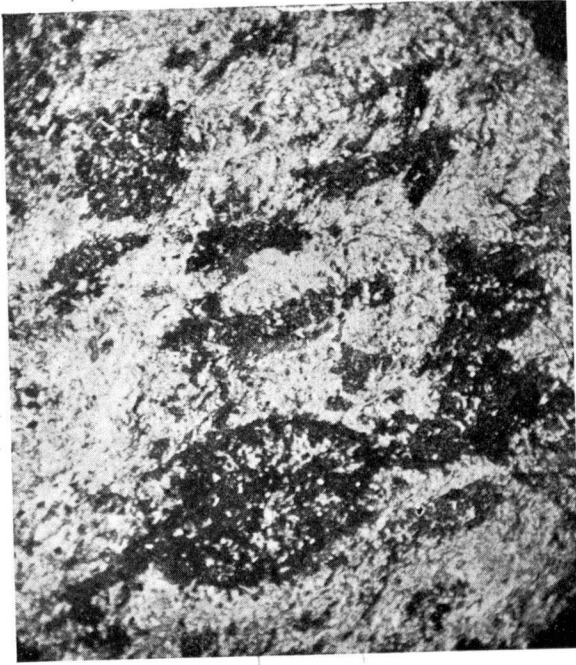
Fig. 11. — Micacita andalucítica con estaurótida de Vallbona. L. ord. 25 d. Pórfidoblastos de estaurótida alterada, sobre base granoblástica, paralela, compuesta de capas de cuarzo y moscovita, con algunas laminillas de biotita y granillos de rutilo, y otras más ricas en biotita con cuarzo y andalucita.
