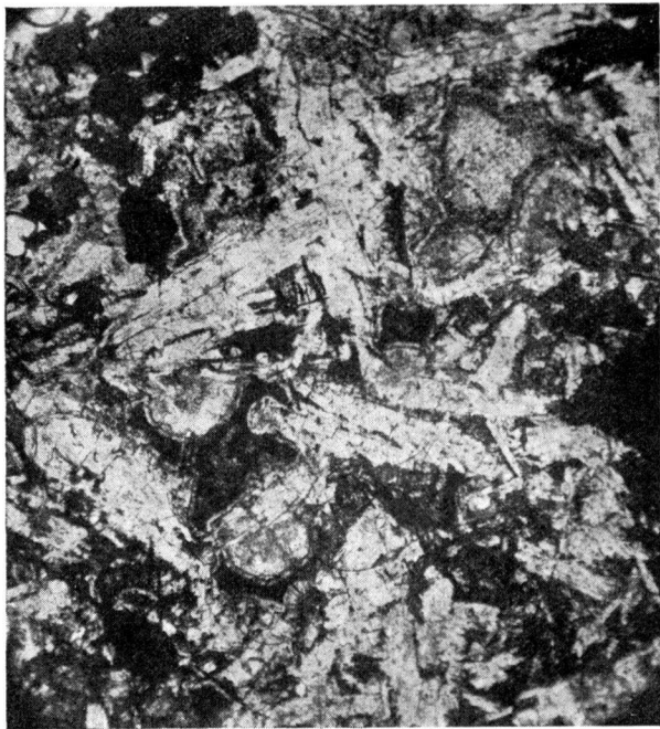
Figs. 9 y 10. — Diabasa de Vallbona. L. ord. y N. 25 d. Cristales de labrador alterado, que se cruzan dejando espacios ocupados por productos secundarios de la alteración de la augita, clorita, limonita; algunas amígdalas de calcita.
