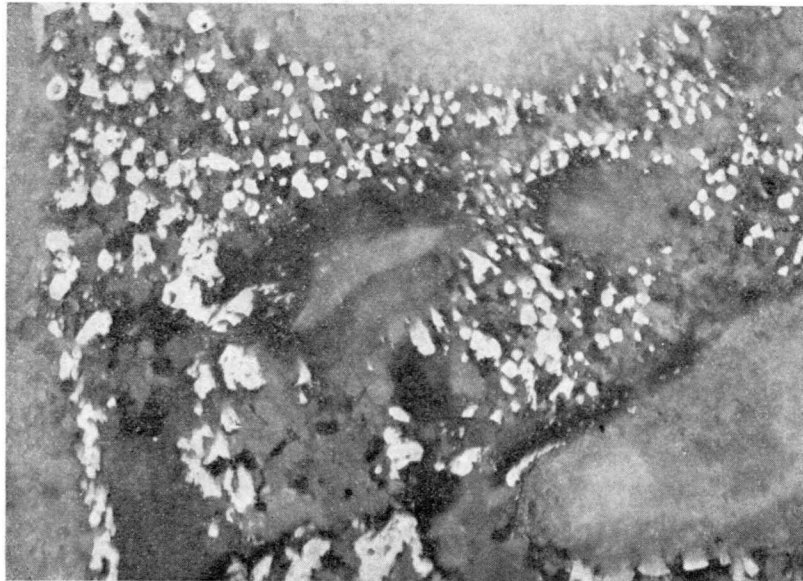
Foto 4.—(Prep. 199-1. Reg. 2.) \times 150 . Nícoles a 80^\circ (Foto I. R. de L.) Constitución del cemento del conglomerado compacto: granos calizos (grises y negros) y galena (blanco). En los bordes se observan cantos sin metalizar.
