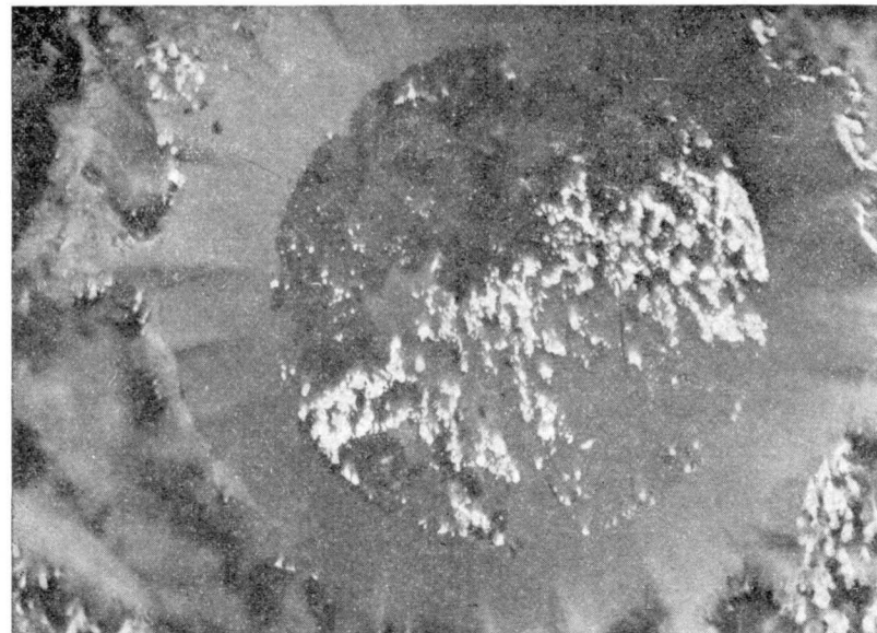
Foto 2.—(Prep. 199-1. Reg. 1.) \times 150 . Nicóles a 80^\circ (Foto I. R. de L.) Canto metalizado del conglomerado compacto, rodeado de una aureola caliza de estructura radial.
