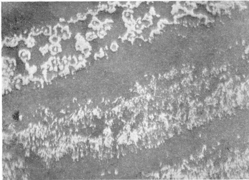
Foto 17.—(Prep. 201-2. Reg. 8.) \times 150 . Nícoles paralelos. (Foto I. R. de L.) Tipo de metalización del banco rojo por bandas de galena de estructura zonal (banda superior) y de estructura acicular (banda inferior).
