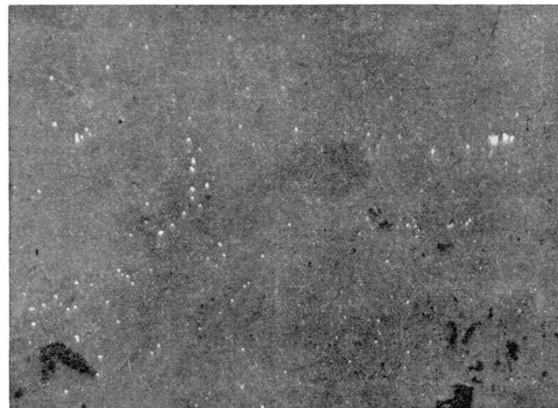
Foto 23.—(Prep. 201-2. Reg. 3.) \times 150 . Nícoles paralelos. (Foto I. R. de L.) Finísima metalización por granillos de galena (blancos) de un diámetro menor de 0,005 milímetros.
